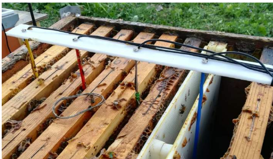
Fig. 4 – Sonda di temperatura multipla composta da 5 sensori da inserire negli spazi interfavo
