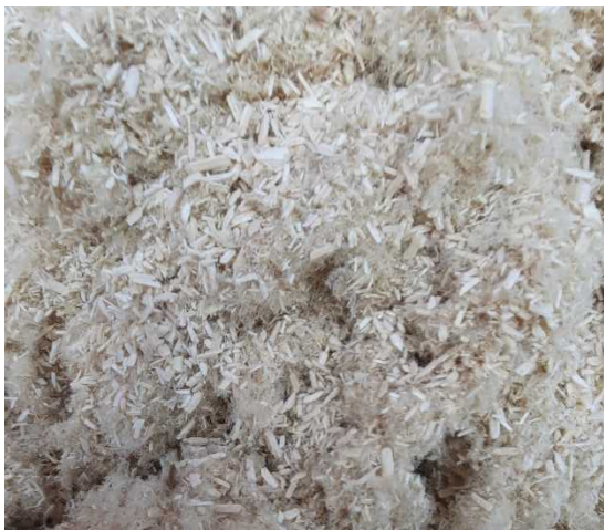
Figura 2: la miscela di fibra corta e di canapulo ottenuto dopo triturazione a martelli.
