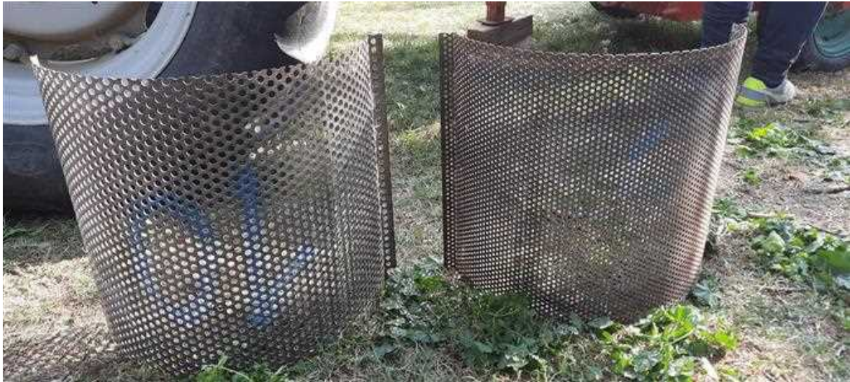
Figura 3: due dei crivelli che possono essere utilizzati nel mulino a coltelli: a sinistra, il crivello da 10 mm, a destra, quello da 6 mm.
