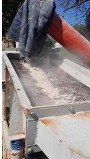
Figura 4: vagliatura separazione. La vita di Archimede del mulino (in arancio) porta il materiale mulinato fino al top dei setacci. La combinazione dell'agitazione e dell'angolo dei setacci permette la separazione del materiale in 3 frazioni (grossa, media e fine) che vengono raccolte in contenitori diversi (non visibile su questa fotografia).
