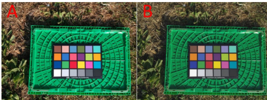
Fig. 4 – A: immagine originale acquisita dal drone DJI™ SPARK™ con il color checker Gretag Macbeth (24 patches). B: immagine dopo calibrazione
