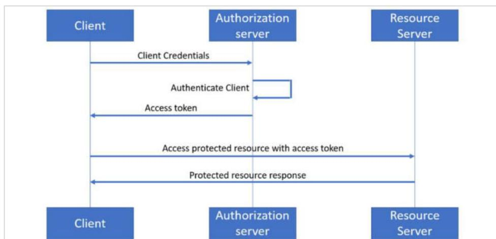
Fig. 2.7 – Schematizzazione del sistema di autenticazione sviluppato per l'accesso alle funzionalità del DSS attraverso il portale ECONET.
