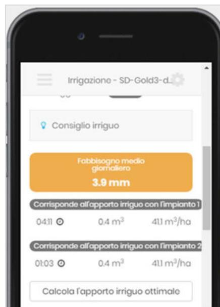
Fig. 3.11 – Il DSS impiega i parametri dell'impianto per convertire il fabbisogno idrico delle colture in consiglio irriguo equivalente (espresso come durata e volume).
