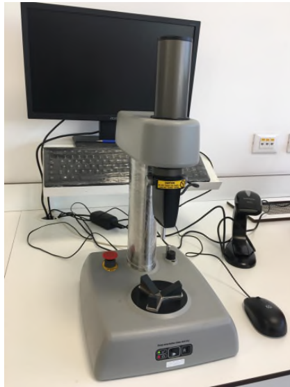
Penetrometro per la misura della durezza
