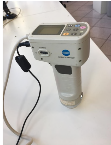
Colorimetro impiegato per la misura del colore della polpa
