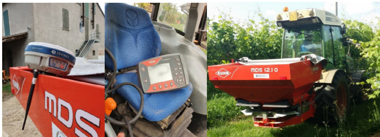
Figura 3.2.9. Applicazione a rateo variabile del fertilizzante tramite spandiconcime Kuhn. A, particolare del ricevitore STONEX con antenna GNSS integrata; B, centralina elettronica di controllo dello spandiconcime; C, macchina in lavoro in campo allestita con deviatori per la localizzazione del fertilizzante a bande in prossimità delle piante.
