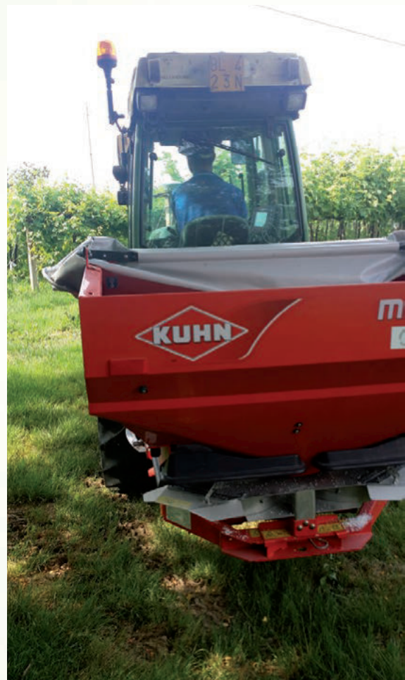
Fig. 5 Applicazione a rateo variabile eseguita con uno spandiconcime (KUHN MDS 12.1) sulla base della mappa di prescrizione. La macchina presenta un deflettore di spargimento per la distribuzione localizzata su due bande alla base delle piante.
