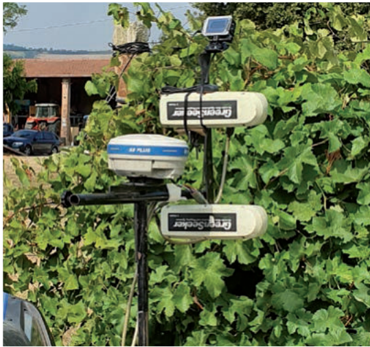
Fig. 3 Sensori GreenSeeker e sistema di posizionamento costituito da ricevitore GNSS Stonex per misura speditiva e geolocalizzazione dell'indice NDVI
