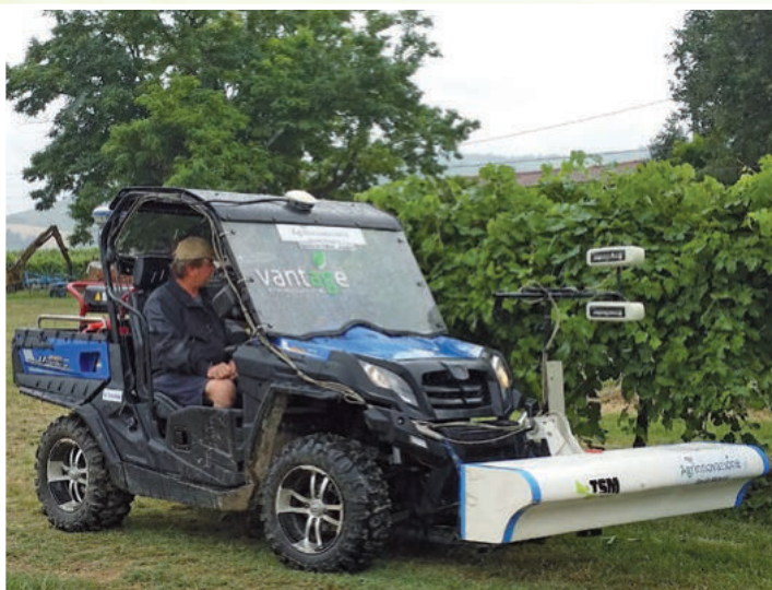
Fig. 2 Sensore Top Soil Mapper Geoprospectors per la misura della conducibilità elettrica del suolo
