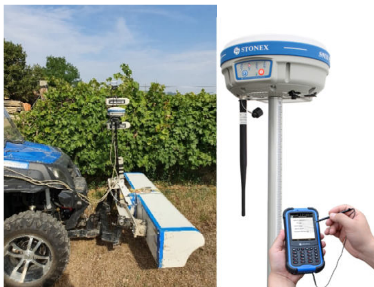
Figura 3.2.1. Sensore Top Soil Mapper (EMI sensor) per la misura della conducibilità elettrica applicato anteriormente al veicolo quad. A destra ricevitore GNSS e datalogger STONEX.
