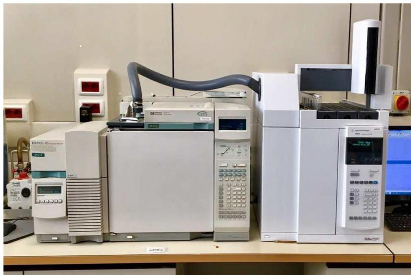
Fig.23. Gascomatografo modello Agilent HP 6890 (*Analisi qualitative*)
