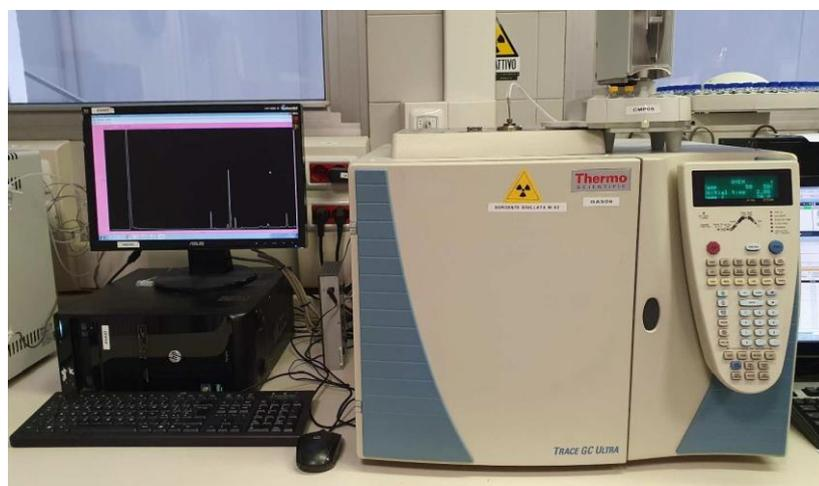
Fig.24. Gascomatografo con rilevatore FID (*Analisi quantitative*)
