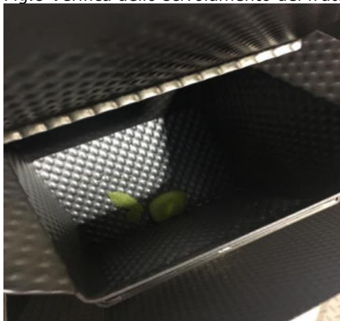
Fig.8 Verifica dello scivolamento dei frutti in fase di costruzione del prototipo.
