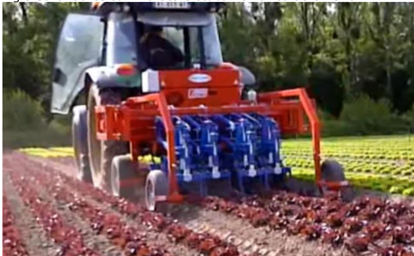
Fig.3 Sarchiatrice con rilevatore ottico Remowed della Ferrari
