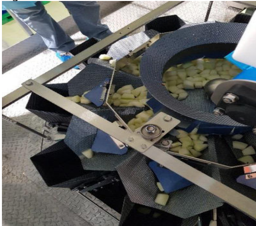
Fig. 5 Il cono centrale vibrante con cella di carico
