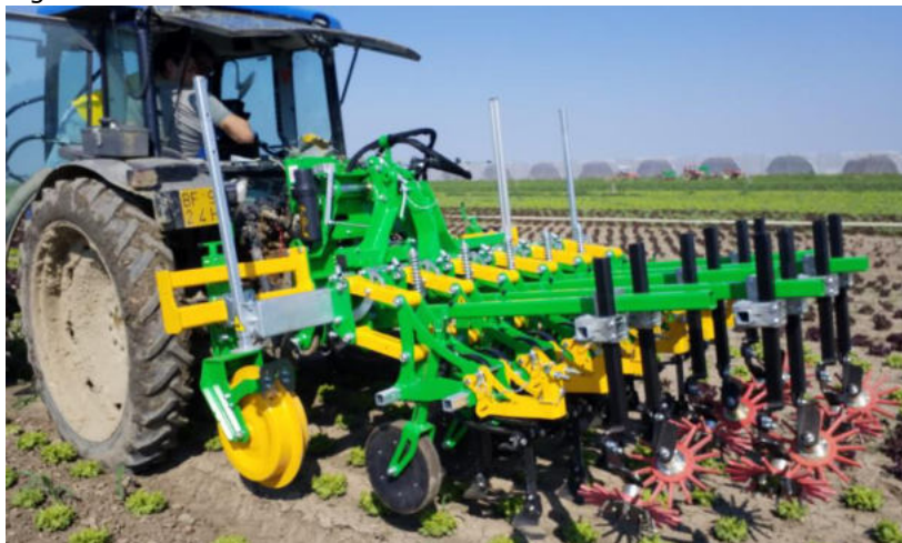
Fig. 2. Sarchiatrice con lettore ottico Maintech.
