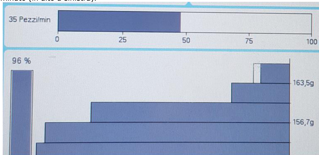
Fig. 16. Particolare del display delle pesatrice che conta anche le vaschette prodotte al minuto (in alto a sinistra).
