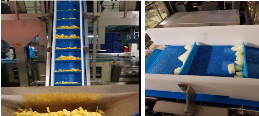
Fig.3 Nastro elevatore con facchinaggi smussati
