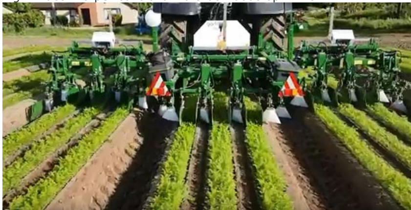
Fig.4 Macchina per controllo malerbe Robocrop In Row
