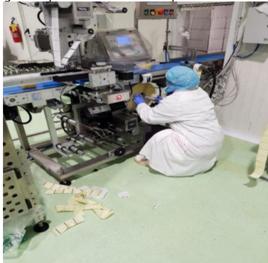
Fig.15. Operatrice intenta a ripristinare la funzionalità della etichettatrice.
