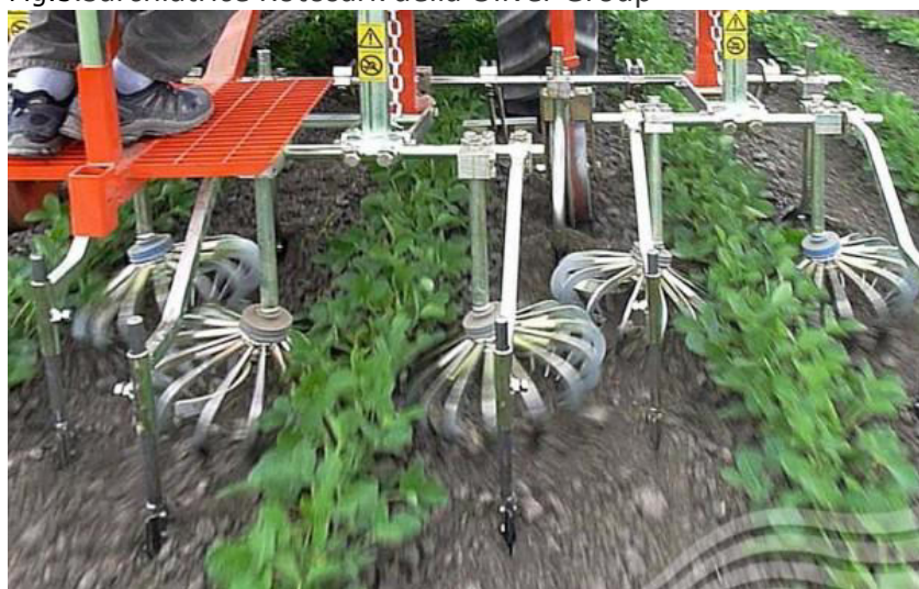
Fig.5.Sarchiatrice Rotosark della Oliver Group
