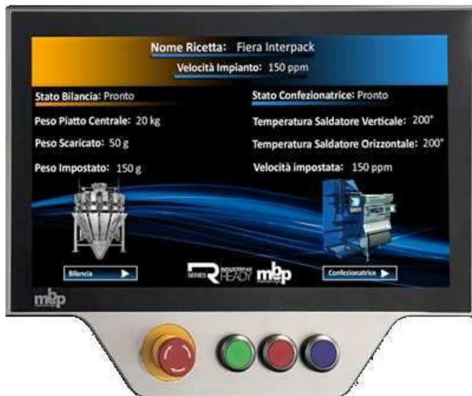
Fig. 6 Quadro di programmazione delle pesatrici in serie
