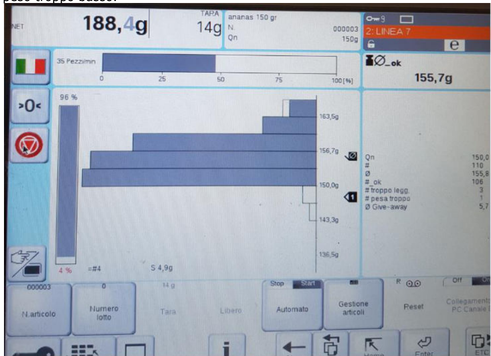
Fig.12. Bilancia che pesa ogni vaschetta al suo passaggio eliminando quelle che hanno peso troppo basso.
