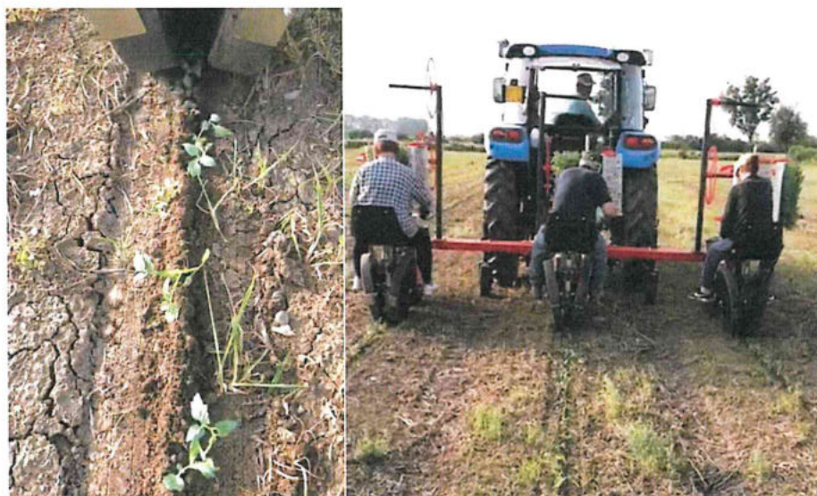
Foto 8a: piante messe a dimora su sodo, anno 2019 – foto 8b: trapianto su sodo con macchina 3 elementi 2019
