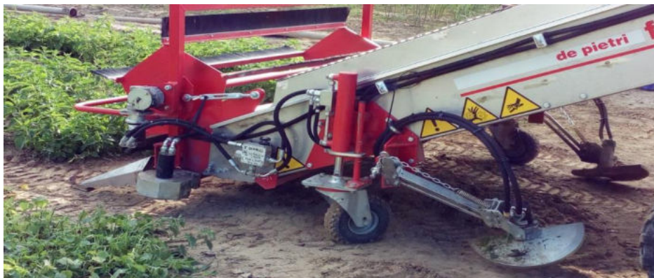
Fig.3 Per favorire la raccolta è stato progettato un nuovo nastro di carico più alto e le slitte tastatrici sono state sostituite da ruote gommatae la cui altezza è comandata dal guidatore.
