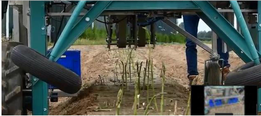
Fig. 13 Prototipo per la raccolta automatica dell'asparago "Green Rabbit della ditta Bagioni di Forli-Italia.
