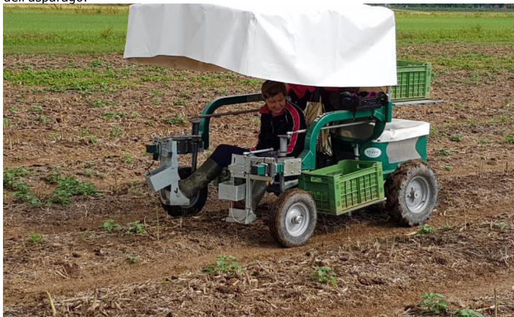
Fig.19 Agevolatrice fra quelle più diffuse in commercio, utilizzata per la raccolta dell'asparago.
