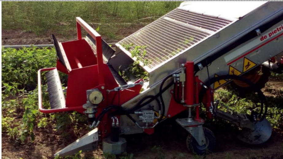
Fig.2 Rete montata sul telaio della macchina a 30 cm dal nastro trasportatore per evitare l'influenza del vento
