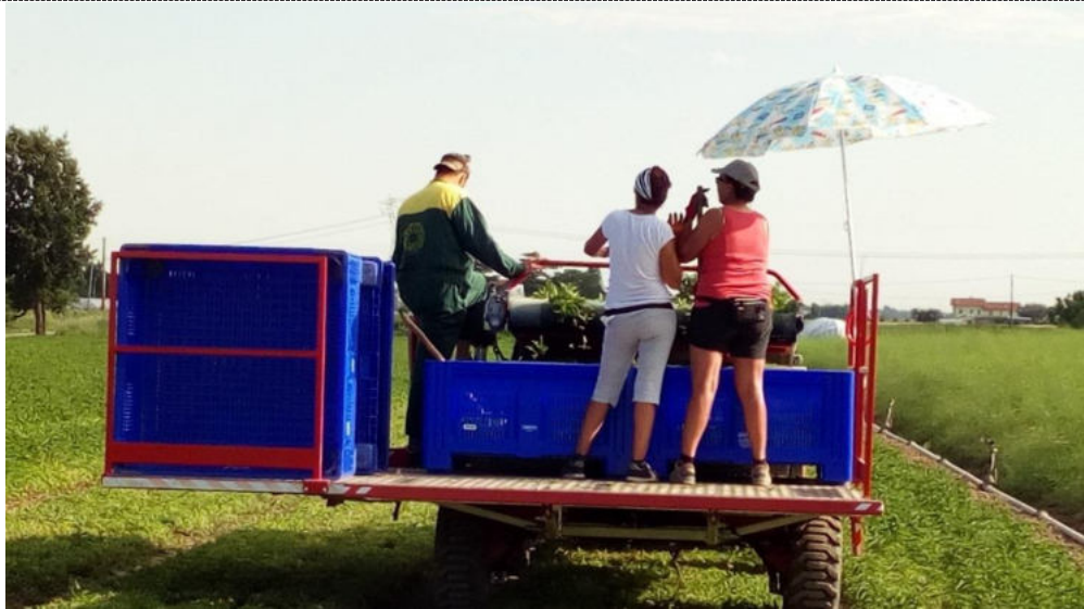
Fig.4 E' stato riprogettato un nuovo piano di carico senza gradini per rendere agevole la movimentazione dei bins e offrendo al tempo stesso l'opportunità di caricare bins vuoti.
