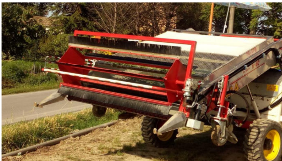
Fig.1. Particolarità del nuovo prototipo: barra di taglio a doppia lama e aspo per agevolare l'arrivo del prodotto sul nastro di carico.
