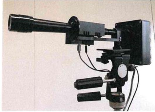
Figura 2. Assetto sperimentale per analisi iperspettrali di mais: AOIS operante nell'intervallo 390÷620 nm, illuminato da una sorgente UV (3) con massima emissione a 365 nm.
