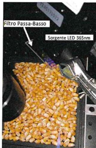
Figura 8. Il filtro passa-basso collocato davanti alla sorgente LED @365nm
