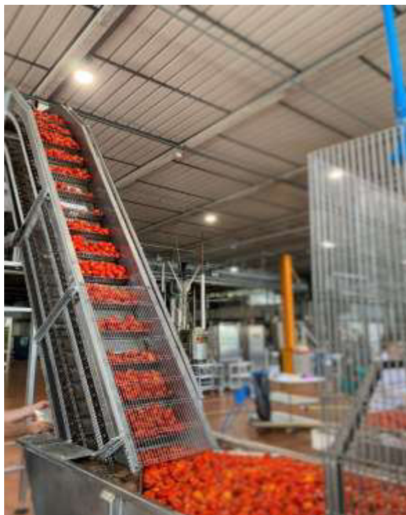
Fig. n. 4 Immagine Lavaggio e Cernita - Impianto pilota SSICA
