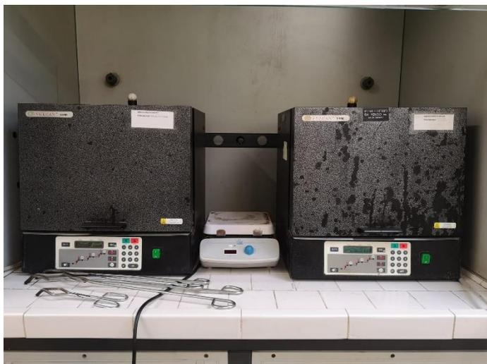
*Figura 6 Stufe utilizzate per incenerimento*
