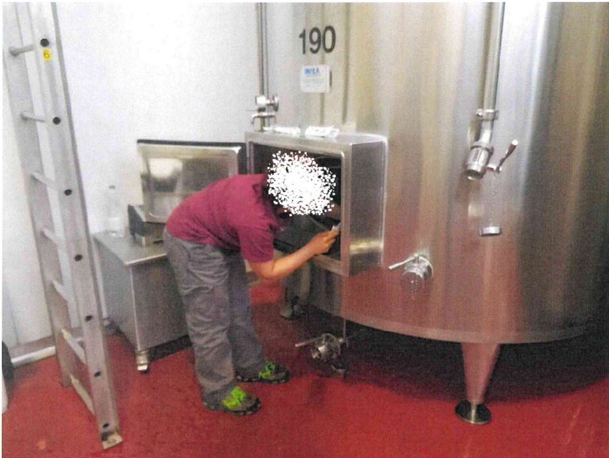
Campionamento microbiologico post trattamento – fondo della vasca
