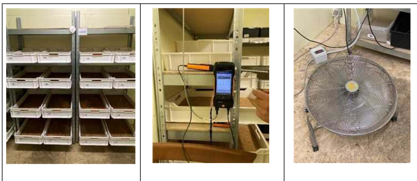
a) La disposizione delle cassette sui ripiani segue l'andamento delle curve di conversione, b) Datalogger di rilevazione della temperatura a diverse altezze c) Posizionamento di una ventola per uniformare la temperatura all'interno della stanza.
