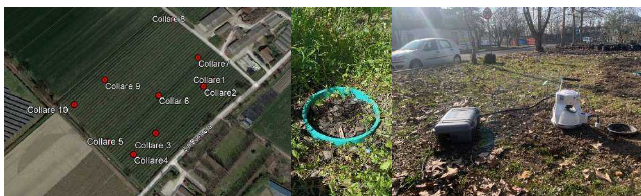
Figura 5. Foto aerea del sito del pereto a Conselice, con il posizionamento dei 10 collari per la misura dei flussi di N 2 O dal suolo (sinistra). Apparato di misura (da destra, la camera dinamica e il collare inserito nel suolo).
