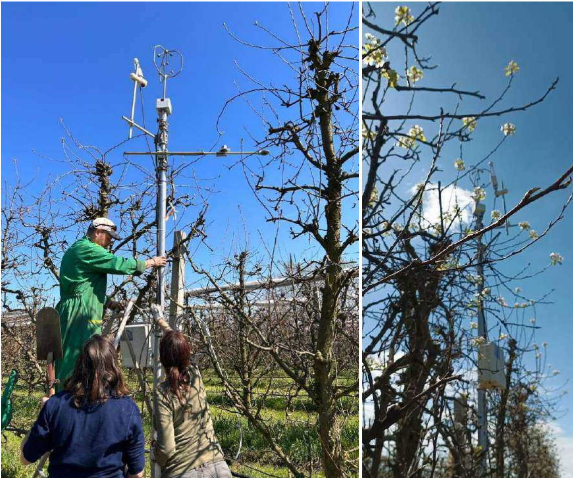
Figura 1. A sinistra: Montaggio della torre eddy covariance (22/3/2023) sul pereto a Conselice: vegetazione all'inizio della gemmatura. A destra: torre di misura operativa sul pereto in fase di fioritura (3/4/2023).
