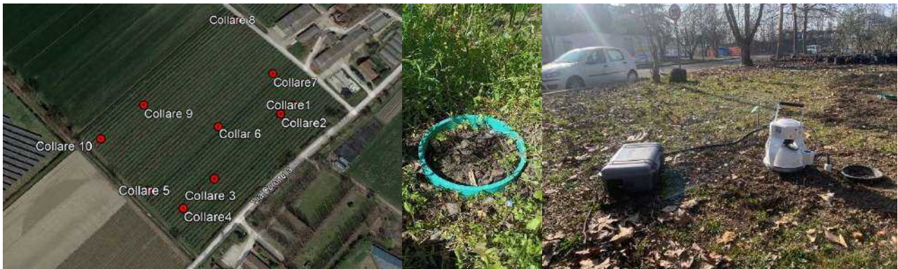
Figure 6. Foto aerea del sito del pereto a Conselice, con il posizionamento dei 10 collari per la misura dei flussi di N_2O dal suolo (sinistra). Apparato di misura (da destra, la camera dinamica e il collare inserito nel suolo).
