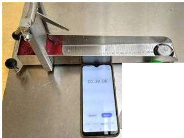
Determinazione della consistenza della purea di frutti rossi mediante consistometro di Bostwick
