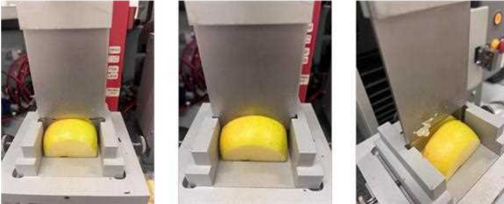
Figura 3- fasi successive del test di taglio referenza mela.
