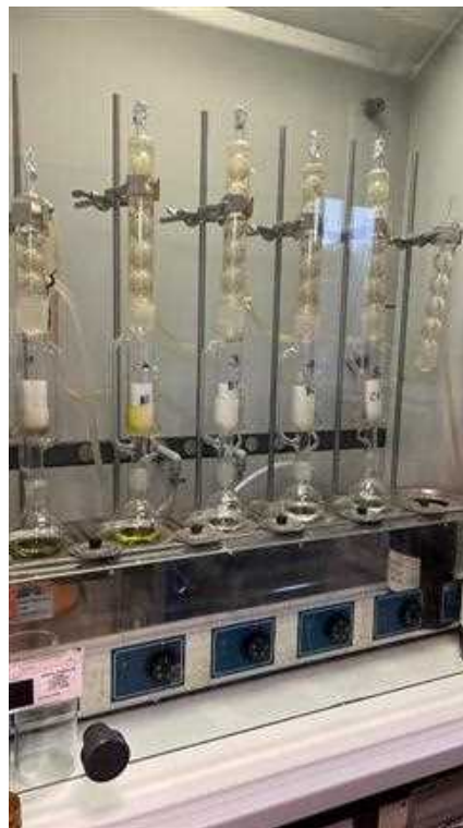
Estrazione dei lipidi con il Soxhlet
