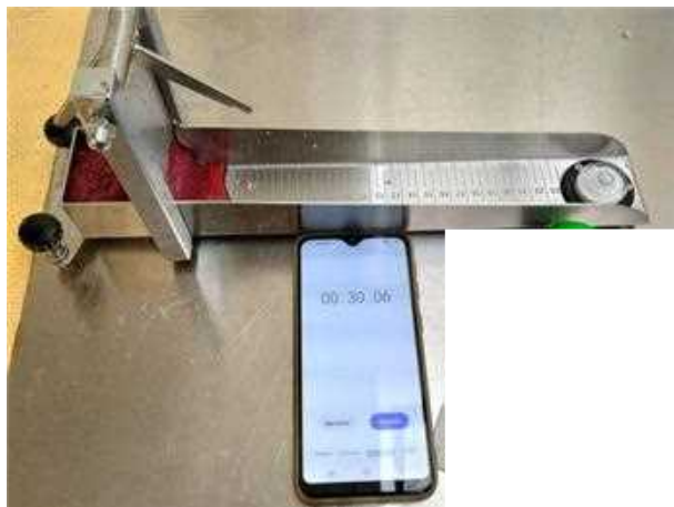
Determinazione della consistenza della purea di frutti rossi mediante consistometro di Bostic
