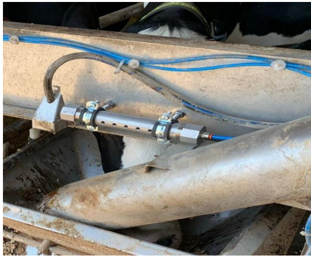
Figura 3. Sonda di aspirazione e dello sniffer applicata nella mangiatoia del robot di mungitura.
