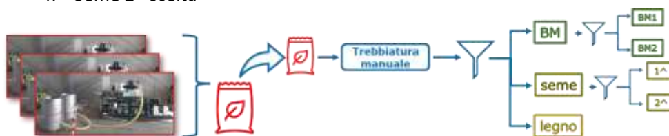
Fig. 4 Schema esperimenti di crioesiccazione/trebbiatura/frazionamento manuali che hanno generato i campioni di biomassa e seme
