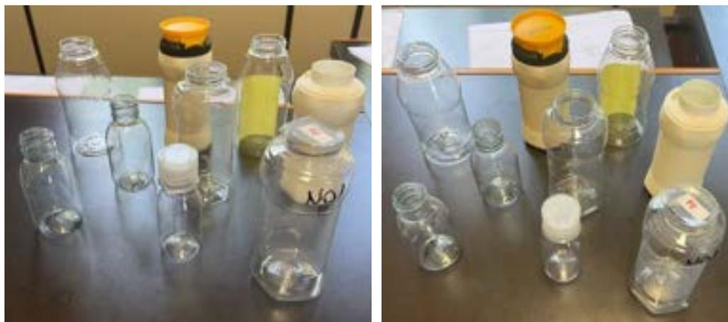
*Figura 1 A2.6. Immagini dei prototipi squeeze testati per il nuovo packaging in plastica riciclata.*
