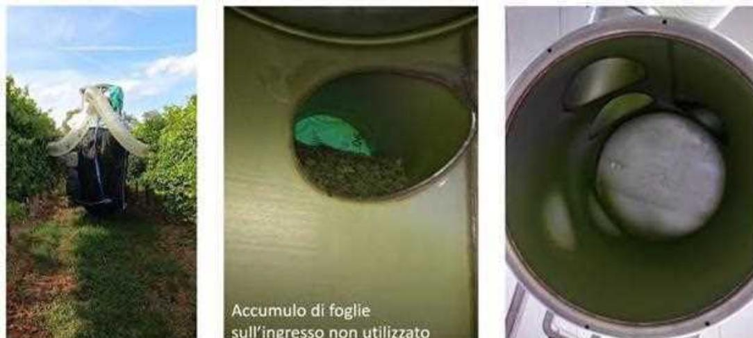
Fig. 12 Primo test con foglie verdi ed ispezione prototipo 2.0
