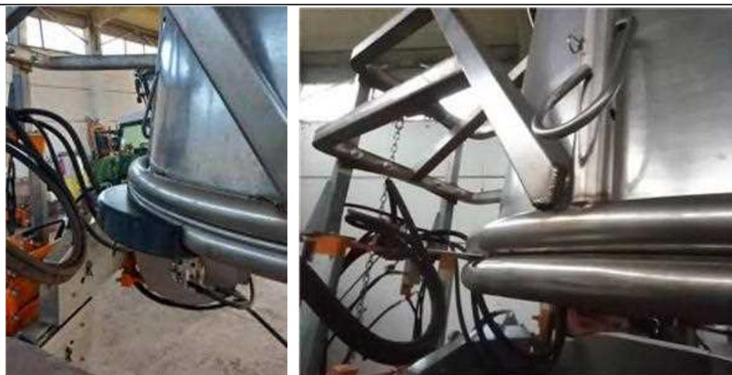
Fig. 16 Aggiunta mensola per facilitazione aggancio clamp prototipo 2.0
