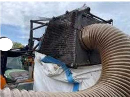
Fig. 4 Intasamento tubi di raccolta sistema precedente
