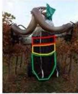
Il progressivo intasamento del sacco-filtro riduce la capacità filtrante e la portata d'aria che si ripercuotono su una capacità inferiore del sacco pari a circa l'80% del volume disponibile.
