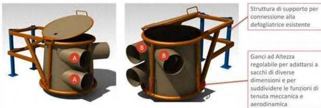
Fig. 9 Rendering 3D della versione 2.0 del sistema
