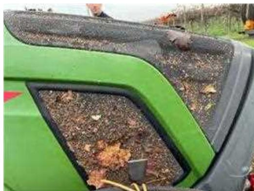
Fig. 2 Intasamento griglie motore sistema precedente
