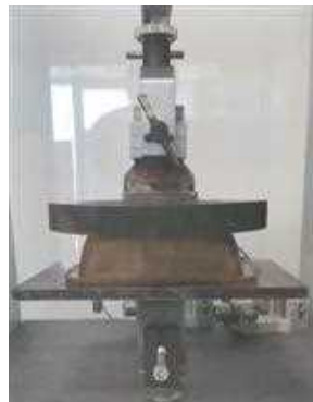
Figura 4.4. Vaschetta in PLA046 in macchina di test
