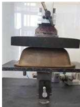
Figura 4.2. Vaschetta in PLA054 in macchina di test
