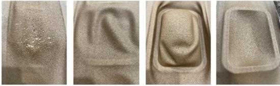
Figura 3.3. Alcuni esempi di campioni danneggiati durante le fasi preliminari di termoformatura
