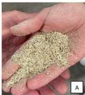
Figura 1.4. Residuo velo (A) e passaggio velo (B) 1000 \mu\text{m} ottenuti dalla macinazione del fieno biotriturato.
