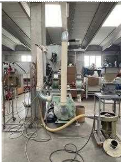
Figura 1.3. Molino a martelli presso Marani Srl
