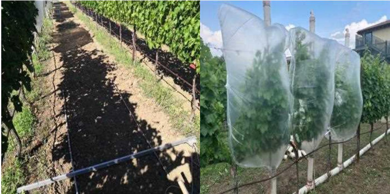
**Foto 2.** Sinistra: misure in campo della luce totale intercettata (LTI) con una barra luminosa che viene progressivamente spostata lungo il filare per catturare l'ombra della chioma al suolo. Destra: un gruppo di tre viti su cui viene misurato, in continuo, lo scambio gassoso dell'intera chioma. La foto è stata scattata l'8 luglio 2022.
