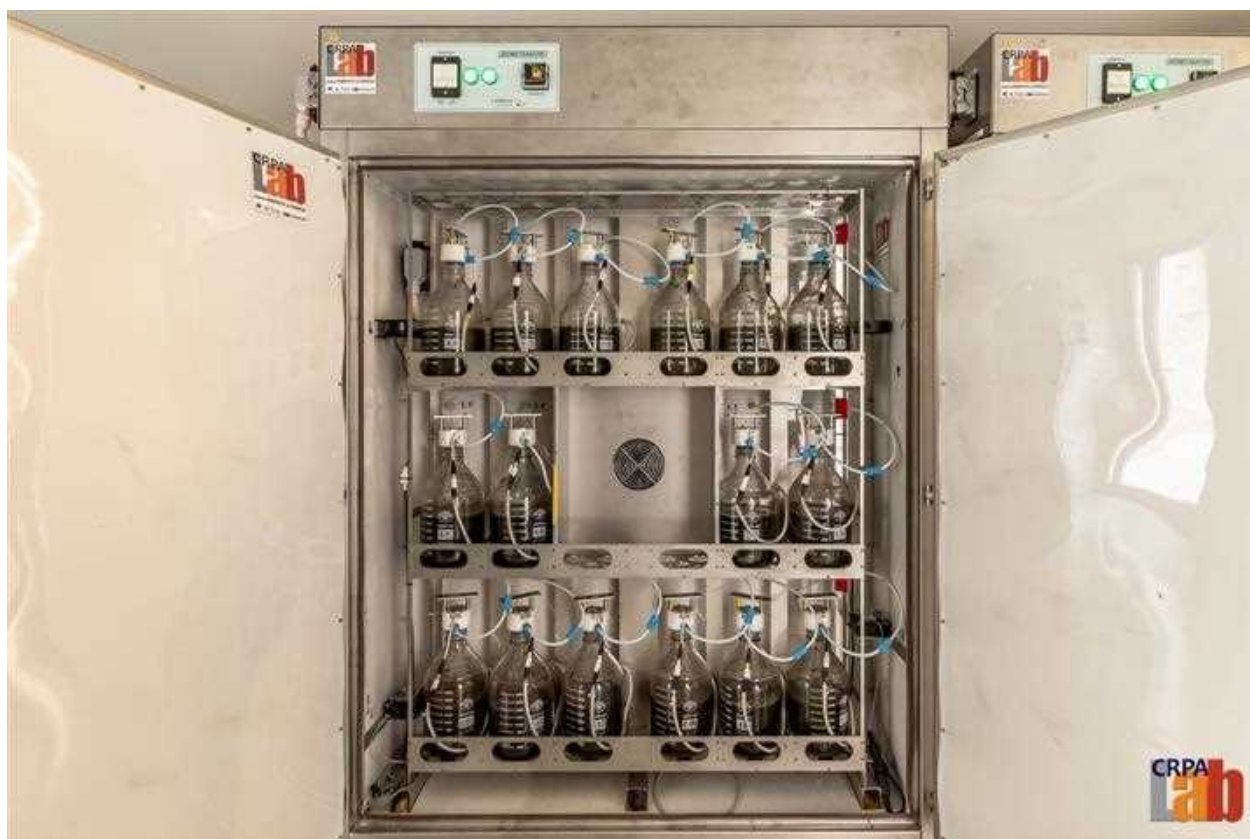
Figura 2- Sistema di misura del potenziale metanigeno
