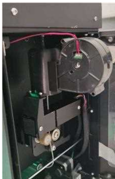
Fig. 2 - Condotto di raffreddamento anulare in PLA+.
