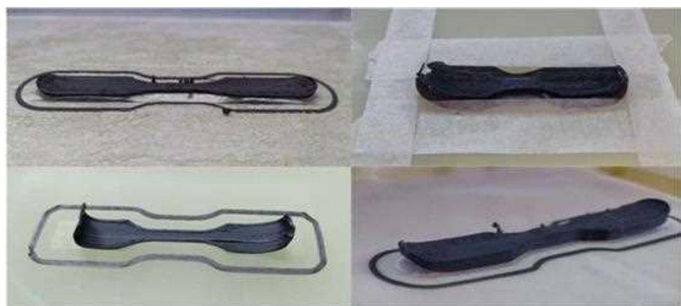
Figura 17. Prove di stampa utilizzando accorgimenti per aumentare l'adesione del materiale alla superficie e limitare lo shrinkage.
