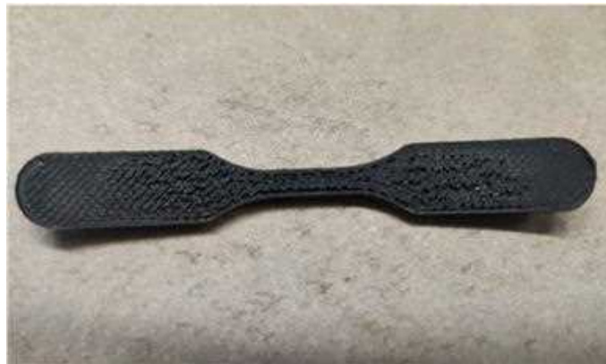
Figura 21. Provino di 3-AG-M-5 prodotto con filamento non sufficientemente regolare
