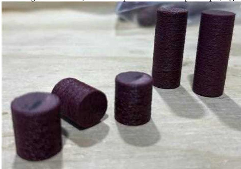
*Figura 10 Tappi prototipo per bottiglia in vetro realizzati con formulazioni PBE006- WGS V11 (10% mm) mediante manifattura additiva.*
