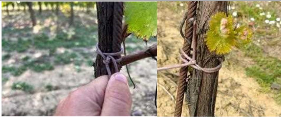
*Figura 9 Stato dei legacci in vigneto dopo 4 mesi dall'applicazione (Giugno 2022, a dx) e dopo 9 mesi (Marzo 2023, a sx).*
