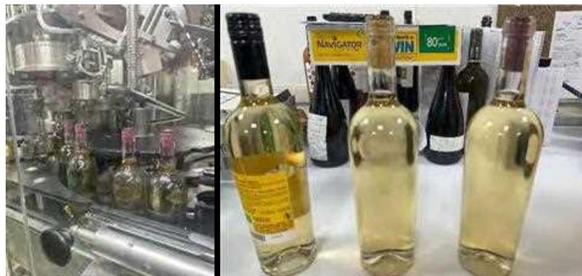
*Figura 12- Utilizzo tappi prototipo su linea di imbottigliamento e verifica della tenuta.*
