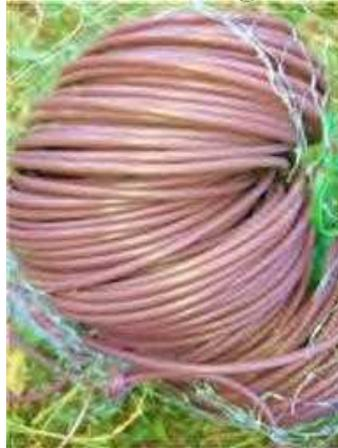
*Legacci prototipi realizzati mediante tecnologia di estrusione*
