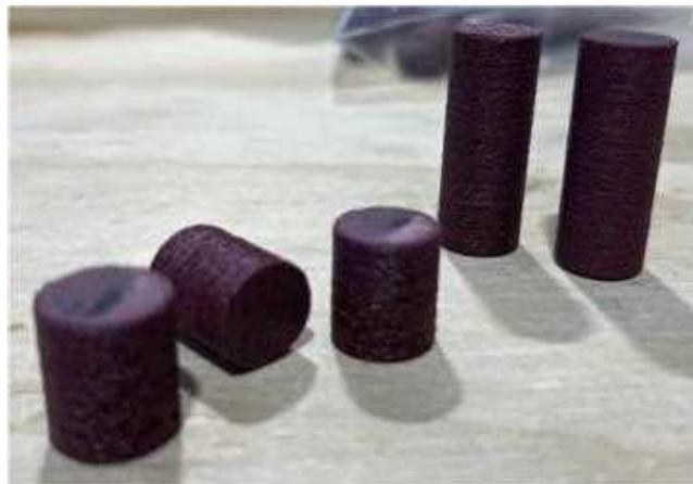
*Tappi prototipi prototipi (a base PBAT, per bottiglie in vetro) realizzati mediante tecnologia di Additive Manufacturing*
