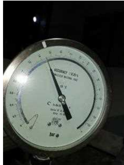
Figura 23 Particolare del manometro di precisione con il quale vengono misurate le pressioni d'esercizio
