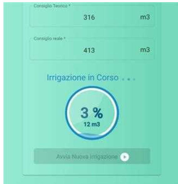
Figura 5 Attuazione dell'irrigazione tramite applicativo di controllo dell'idrante di consegna
