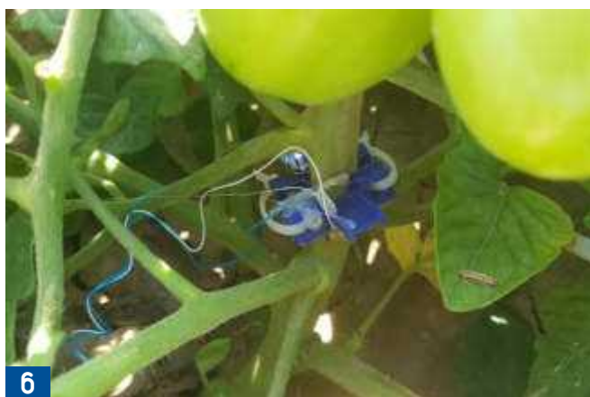
6. Sensore di composizione ionica della linfa - Bioristor del Cnr-Imem su piante di pomodoro 7. Automazione dell'irrigazione a rateo variabile su semovente ad ala piovana avvolgibile
