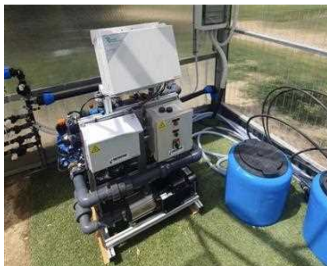
Figura 6 Banco fertirriguo adoperato per la sperimentazione
