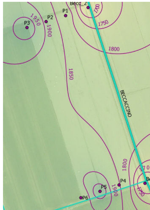
Figura 19: rappresentazioni IDW dell'andamento teorico della conducibilità elettrica nella falda del sito di Valle Gaffaro nei due momenti 31/07/2018 (a sin.) e 03/10/2018 (a des.). I valori sono in \mu\text{S}/\text{cm} . In basso, la scala colorimetrica utilizzata.
