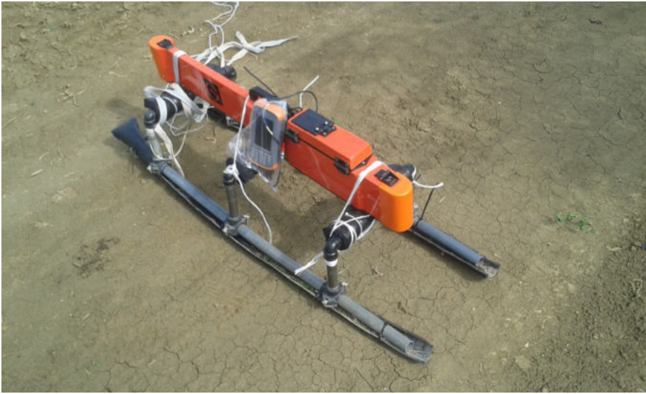
Figura 36: Strumento EM38 con slitta per il traino manuale
