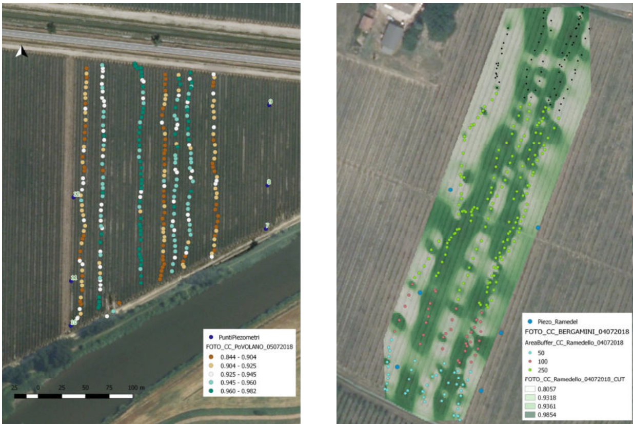
Figura 29: A sinistra fase iniziale di elaborazione GIS dei punti fotografati (sito di Pomposa – rilievo del 5 luglio 2018); a destra copertura areale ottenuta tramite interpolazione dei valori dei punti con algoritmo IDW (sito di S. Felice – rilievo del 4 luglio 2018).
