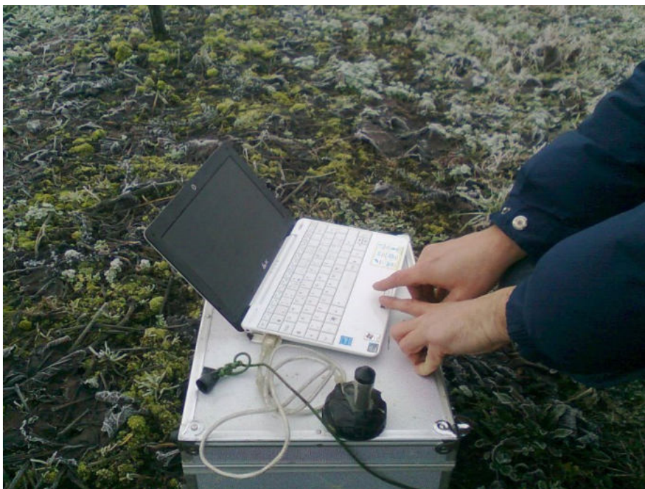
Figura 9: Scarico dati dal Diver
