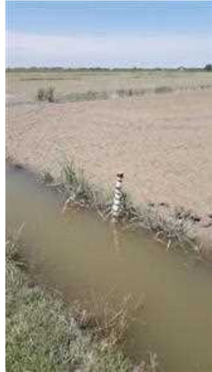
Figura 3: Immagini dei due piezometri con Diver posizionati per il controllo dei livelli di acqua nella camera di risaia: a sinistra, entrata; a destra, uscita.
