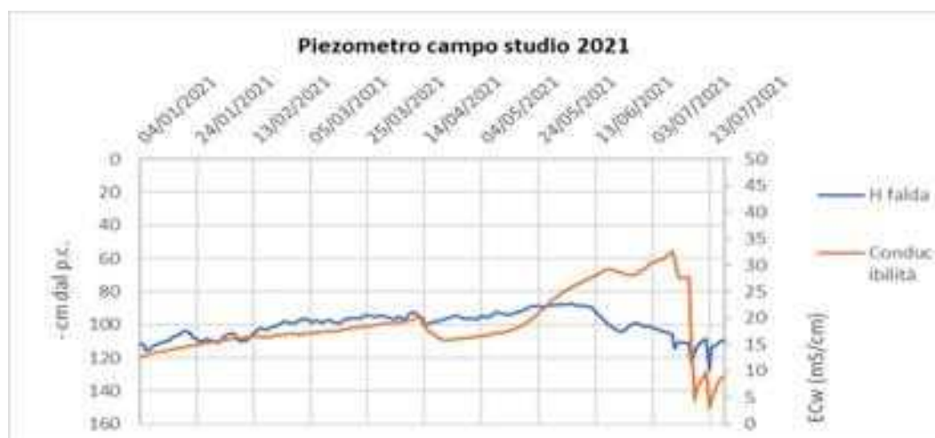
Grafico 3: Andamento del livello di falda nel piezometro installato nel campo studio 2021, confrontato con la conducibilità elettrica rilevata dal sensore. Significativa la risalita di conducibilità nel periodo estivo fra fine maggio ed il 10 luglio (avanzamento del cuneo salino?).
