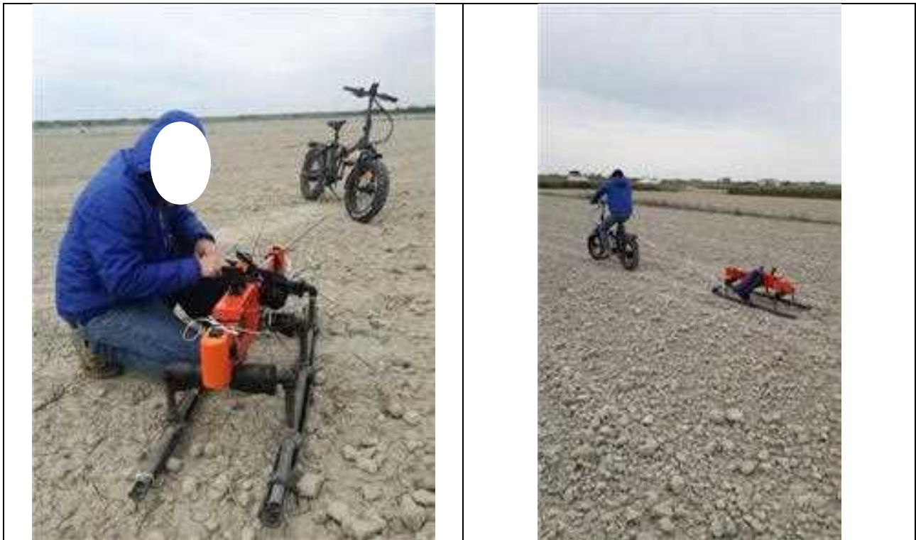
Figura 6: Fasi di preparazione e di rilievo tramite EM38 lungo la superficie della risaia, a fine aprile 2021.
