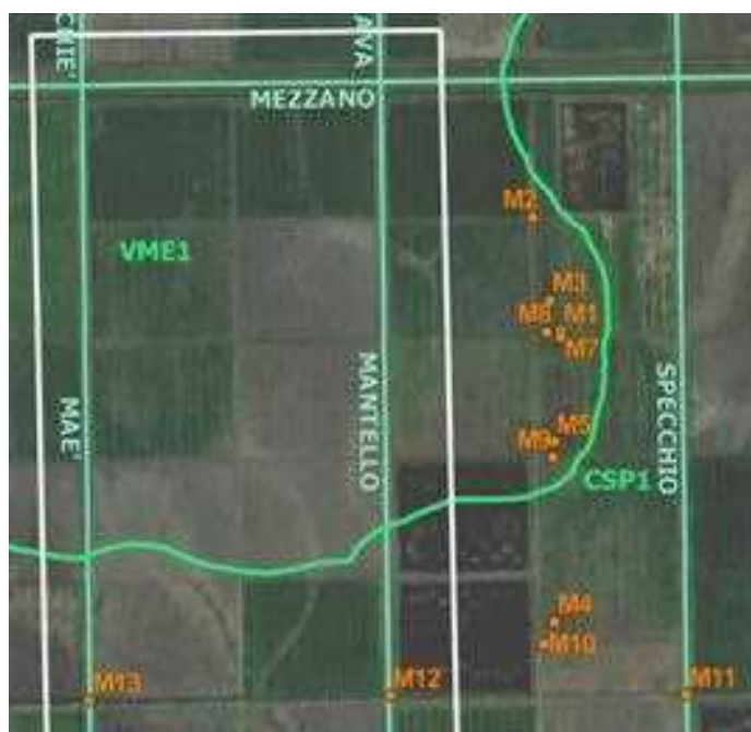
Figura 5: A sinistra: lettura con freatimetro del livello di falda nel nuovo piezometro posato in corrispondenza dell'area di studio. A destra: canali irrigui e di scolo limite centro-settentrionale dell'area di studio (in bianco) e punti di rilievo acque e suolo. M1 corrisponde all'ubicazione del piezometro posato a luglio 2021. In verde, Carta dei suoli regionale 1:50000 ed. 2021 e relative sigle delle Unità cartografiche.
