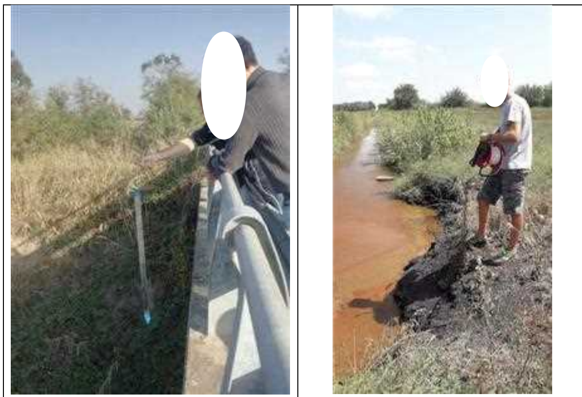
Figura 5: prelievo di campioni di acqua dal Collettore Mezzano tramite Bailer (a sinistra) e misurazione della conducibilità elettrica tramite freatimetro in un canale di scolo (a destra).
