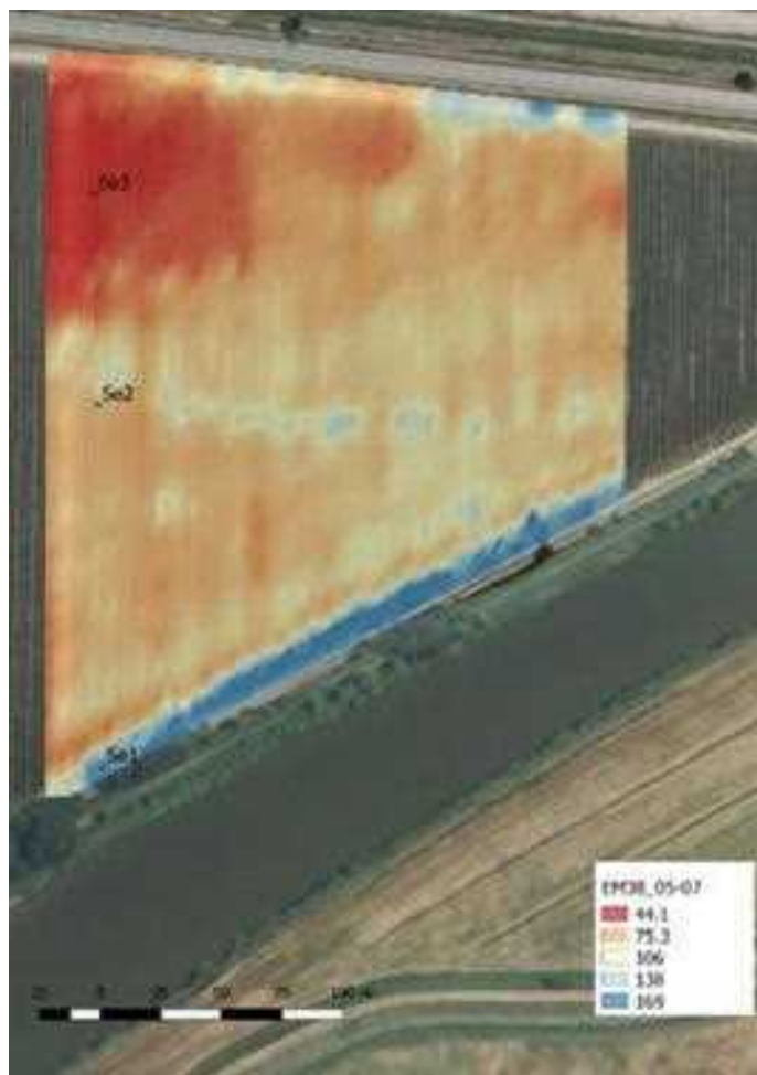
Figura 6: Mappa della conducibilità elettrica apparente del suolo misurata con EM38 con interpolazione spaziale IDW.
