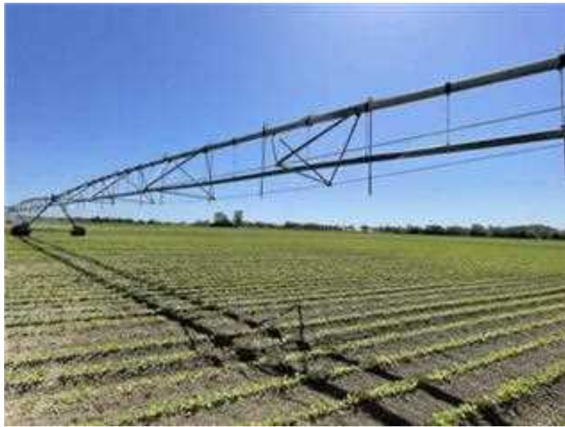
Fig. 6. Pivot con centralina per l'irrigazione a rateo variabile
