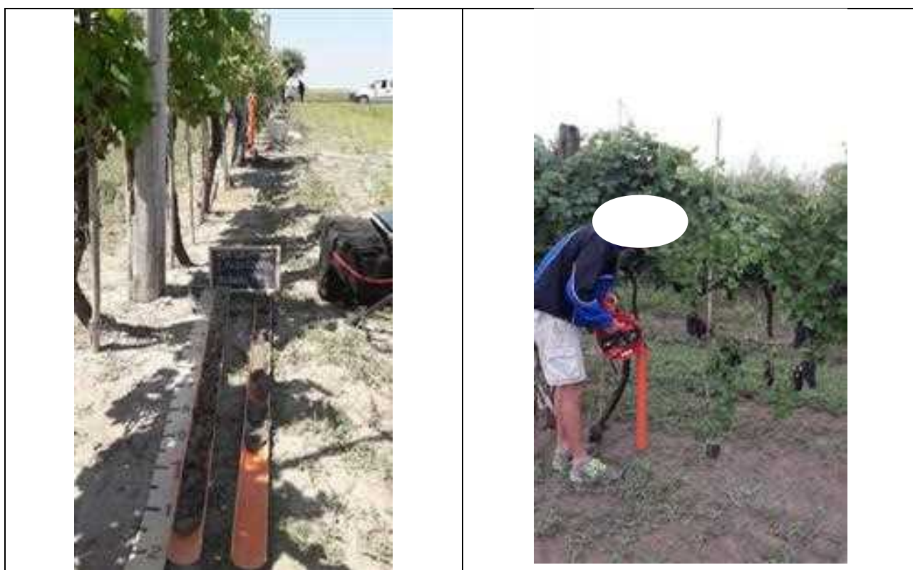
Figura 14: A sinistra: carote di suolo disposte per la descrizione pedologica dopo la posa del piezometro G2, visibile sullo sfondo. A destra: lettura tramite freatimetro del livello di falda e della conducibilità elettrica.
