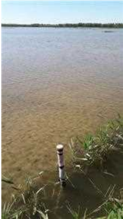
Figura 3: Immagini dei due piezometri con Diver posizionati per il controllo dei livelli di acqua nella camera di risaia: a sinistra, entrata; a destra, uscita.
