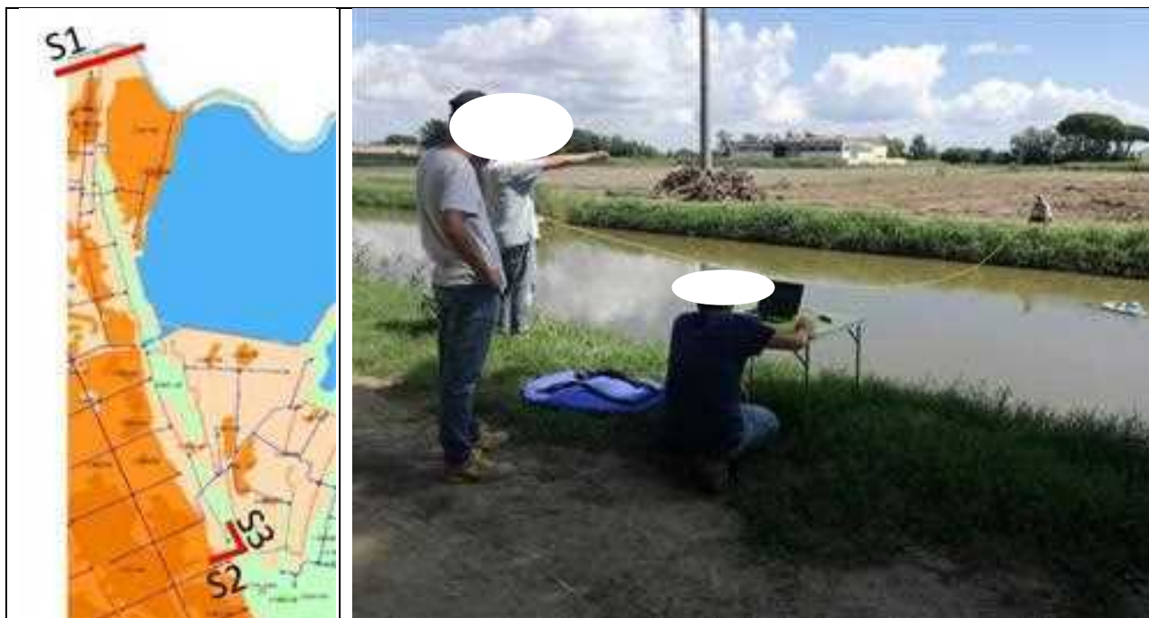
Figura 8: a sinistra: ubicazione delle sezioni in cui sono state effettuate le prove; a destra: letture tramite River Surveyor nella sezione più meridionale del canale di Gronda.
