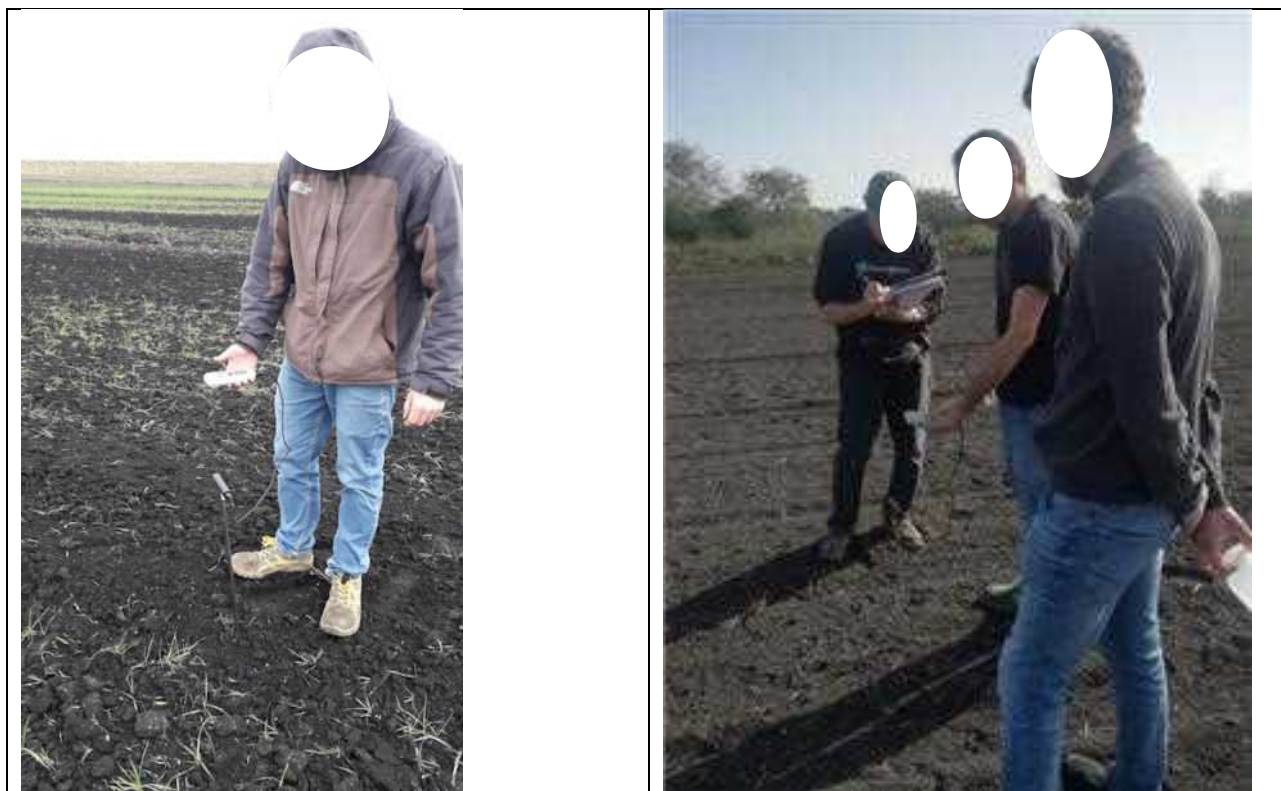
Figura 7: Misure della conducibilità elettrica nel terreno tramite Field Scout in diversi periodi: inverno (a sinistra) ed estate (a destra).
