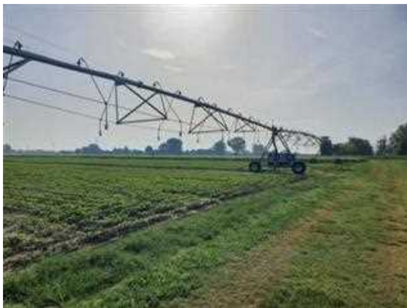
Fig. 5. Rainger con centralina per l'irrigazione a rateo variabile
