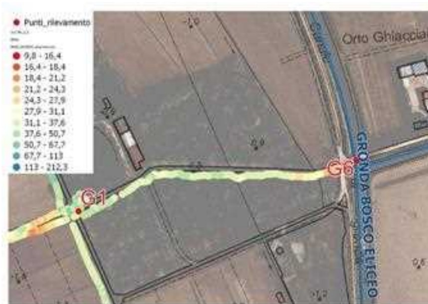
Figura 18: Rilievo con EM38 del 17 agosto 2022, nel tratto di circa 300 m fra il piezometro G1 e il canale di Gronda - sezione Valle Isola. G6 corrisponde all'ubicazione del tubo di calma con strumento Diver, per la misura del livello del tirante all'interno del canale.
