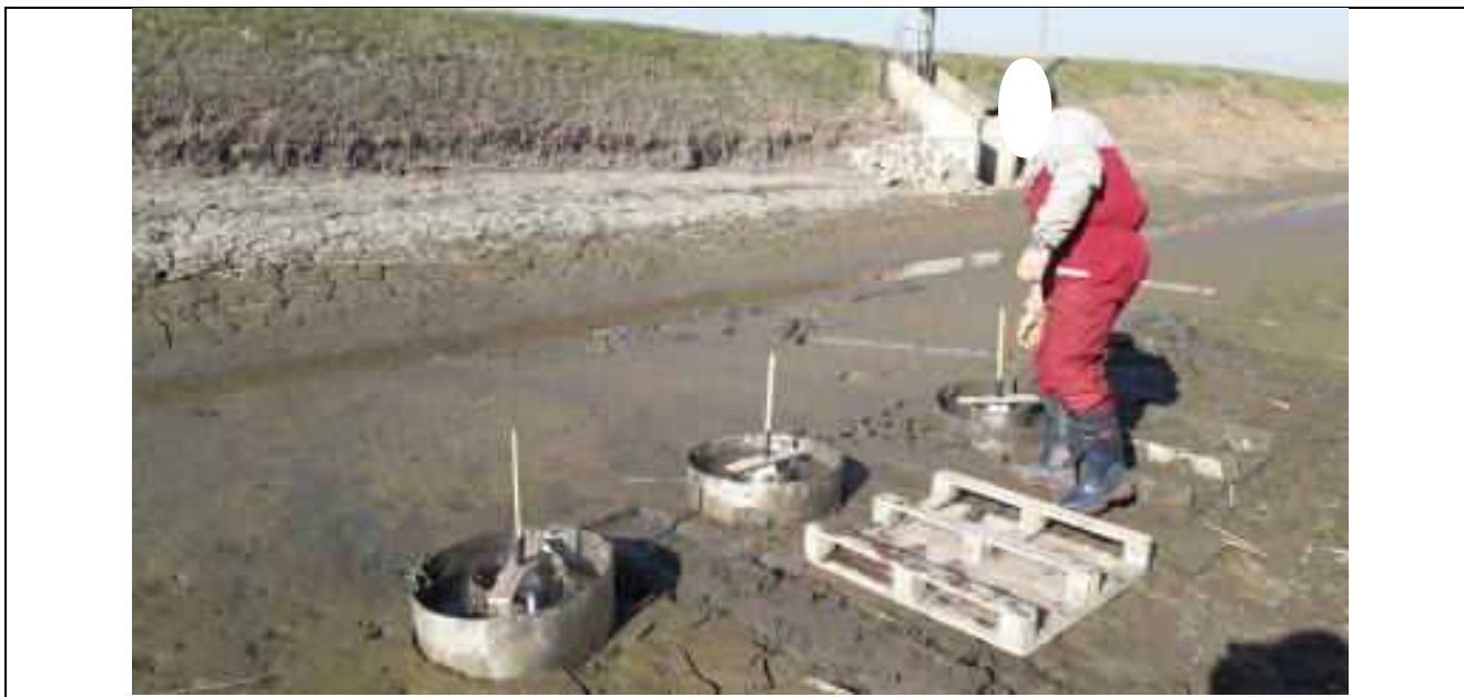
Figura 10: Batteria di tre doppi cilindri posati sul fondo del canale di Gronda.
