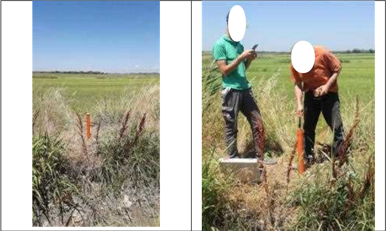
Figura 8: A sinistra: Piezometro posizionato sull'argine e, sullo sfondo, la risaia; appare evidente la differenza di quota fra il rilievo arginale e il piano campagna; a destra: posizionamento all'interno del piezometro dello strumento CTD Diver.
