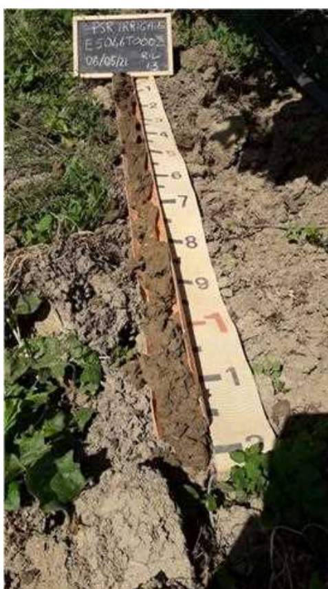
Figura 1: A sinistra, foto della sequenza di orizzonti rilevata in campo in uno degli appezzamenti (nella fattispecie Golinelli). A destra, piezometro da 3 m, con protezioni, installato lungo la fila presso il pereto nell'appezzamento Tomasatti.
