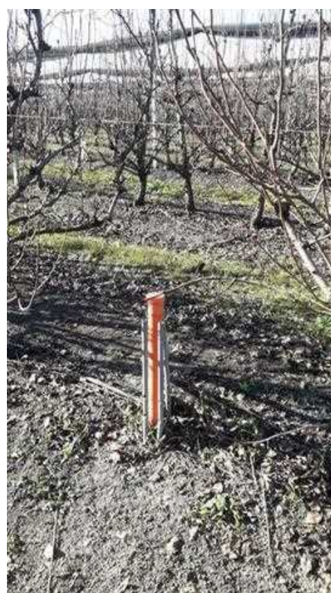
Figura 1: A sinistra, foto della sequenza di orizzonti rilevata in campo in uno degli appezzamenti (nella fattispecie Golinelli). A destra, piezometro da 3 m, con protezioni, installato lungo la fila presso il pereto nell'appezzamento Tomasatti.
