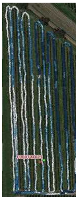
Figura 8 -: Mappa dei valori puntuali di ECa rilevati in data 19/05/2022 nell'appezzamento Golinelli. Il punto verde e la sigla indicano l'ubicazione del piezometro.
