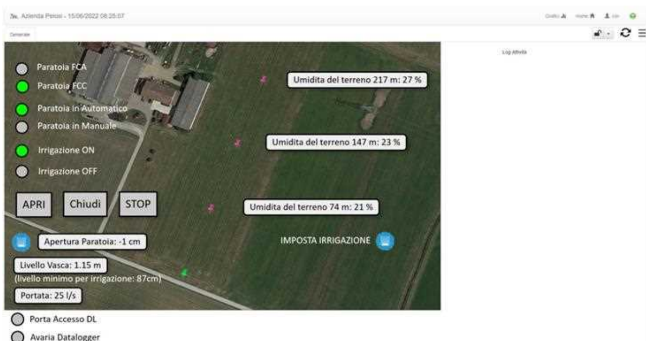
Figura 15: Portale di gestione della paratoia
