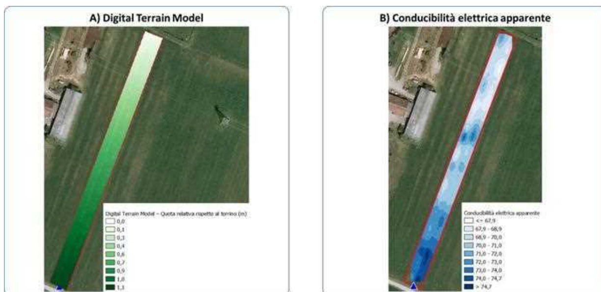
Figura 25: Digital Terrain Model – Quota relativa rispetto al torrino (A) e Rilievi della conducibilità elettromagnetica apparente (B)
