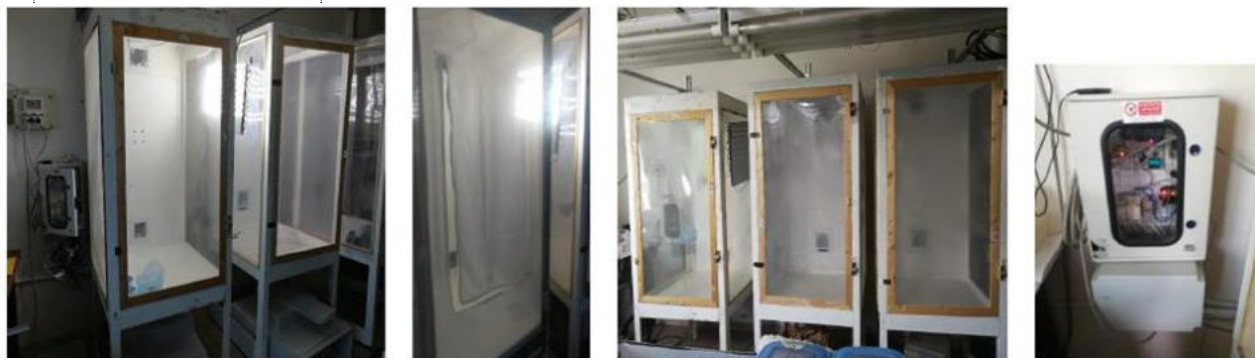
Figura 1: Immagini relative alle 3 unità collocate presso UCSC Piacenza e la micro PLC che ne gestisce in remoto il controllo in tempo reale dell'umidità e della temperatura.
