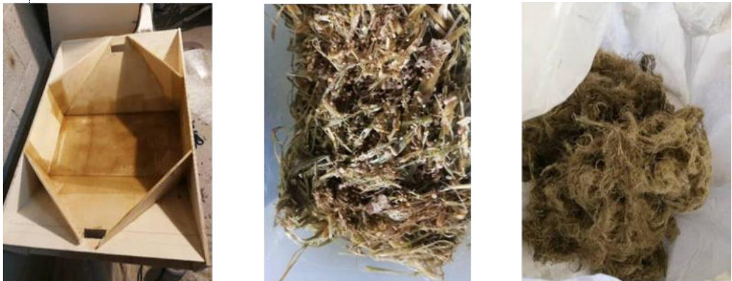
Figura 5: Contenitore per il trattamento con larve della fibra di canapa macerata (a sinistra). Canapa macerata sottoposta a trattamento con le larve (in centro). Fibre di canapa post trattamento ed asciugate naturalmente (a destra)
