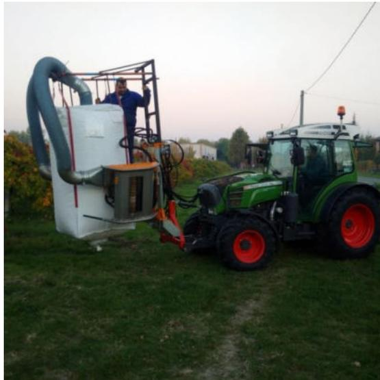
**Figura 3.1.9: Modifica della macchina per convogliare il prodotto in un saccone tipo Big Bag portato direttamente dalla defogliatrice.**
