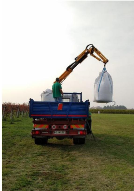
Figura 3.1.17. Autocarro dotato di gru per il caricamento autonomo dei Big Bag.
