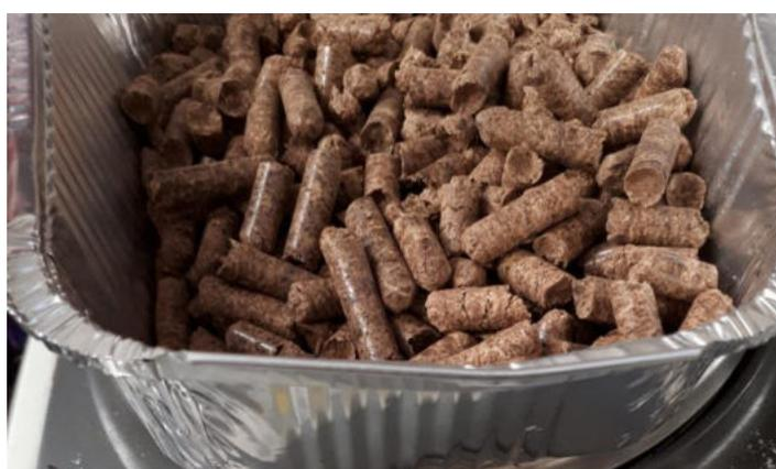
**Figura 3.2.11:** Pellet di potature di vite prodotto da Caeb e sottoposto alle analisi.
