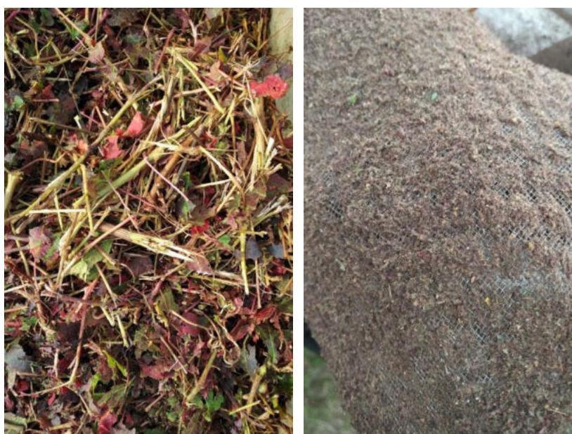
**Figura 3.1.15: frammenti di foglie e tralci inumiditi e dettaglio otturazione della rete a maglie sottili.**
