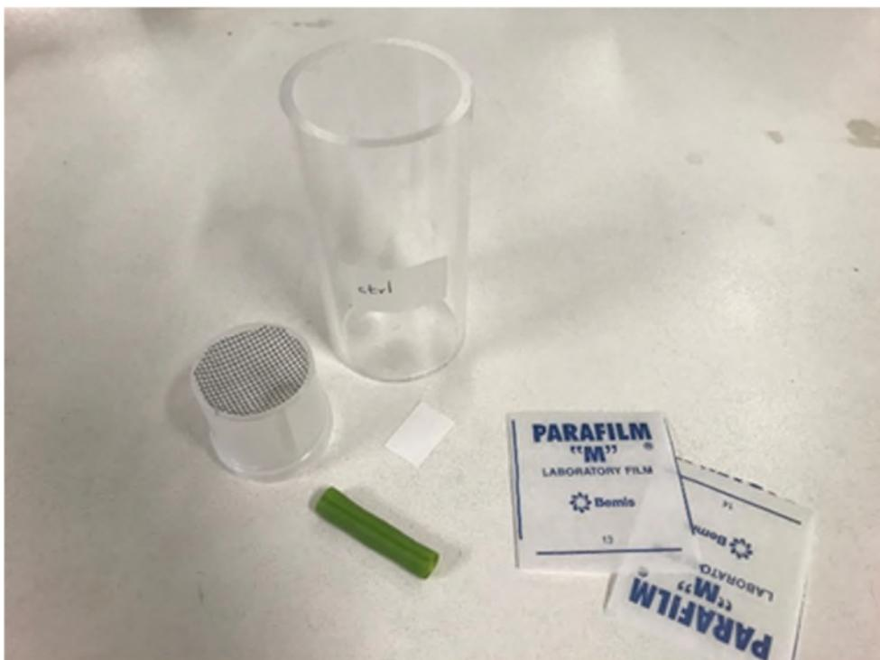
**Figura 3.1.4.** Rappresentazione del sistema per valutare la tossicità volatile di molecole contro neanidi L2 di cimice asiatica.
