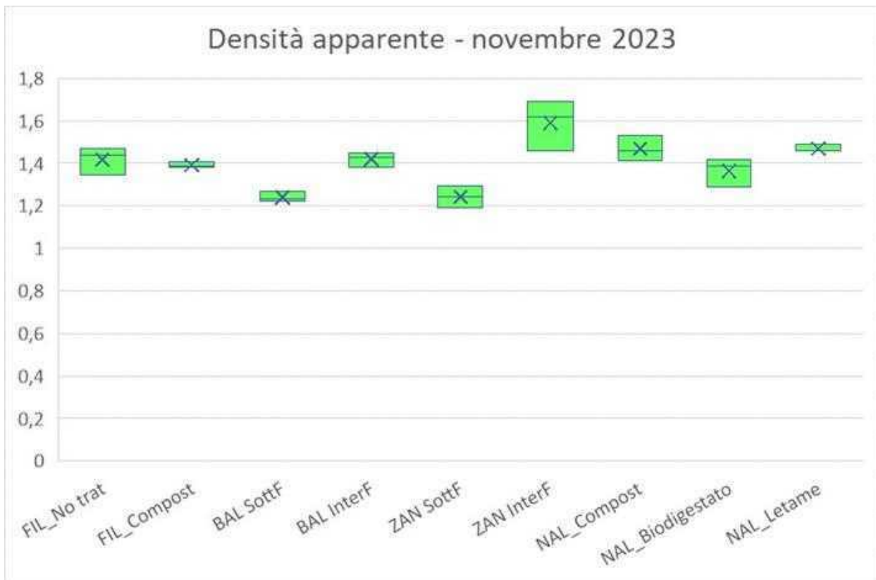
Grafico n 7: evidenzia la variabilità dei valori di densità apparente monitorati nelle 3 aree di campionamento di ciascun sito.
