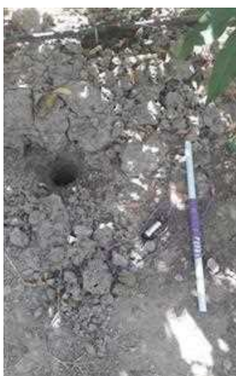
Figura 2: (sinistra) foro praticato con trivella, strumento Diver e cavo con barretta per la sospensione sul foro; (destra) rappresentazione grafica dei parametri di calcolo utilizzati nell'Inverse Auger Hole in: Oosterbaan and Nijland (1994).
