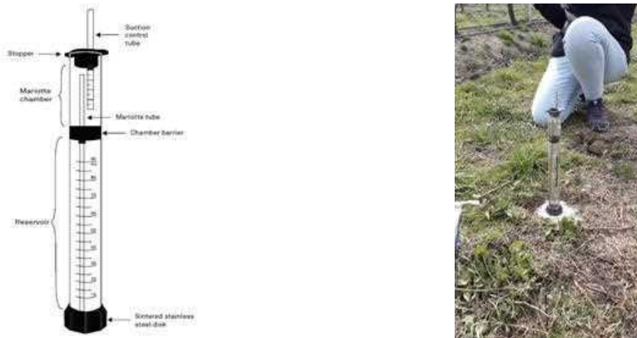
Figura 1: A sinistra, schema delle componenti del Mini Disk, estratto dal manuale d'uso. A destra, l'infiltrometro utilizzato in campo; si noti il sottile strato di sabbia silicea alla base, stesa per assicurare un miglior contatto fra le micro-irregolarità del terreno e la base filtrante dello strumento
