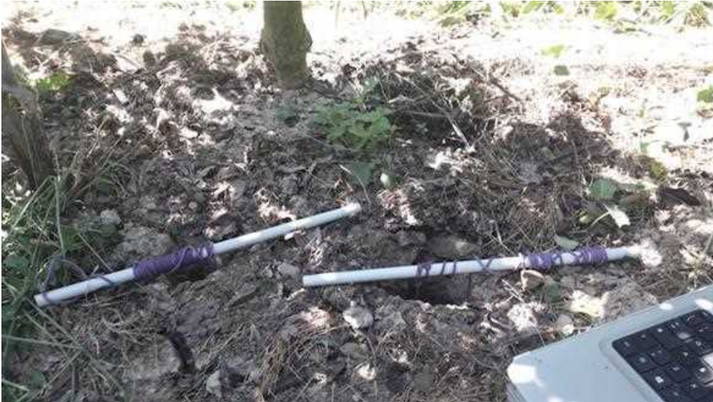
Figura 1: Prova di Inverse Auger Hole; si notano i due fori a 50 e 100 cm, con asticelle e cordini a cui sono sospesi i Diver.
