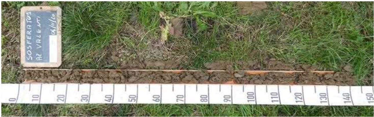
Esempio foto della trivellata ripresa integralmente, con corretta disposizione del metro e della lavagnetta
