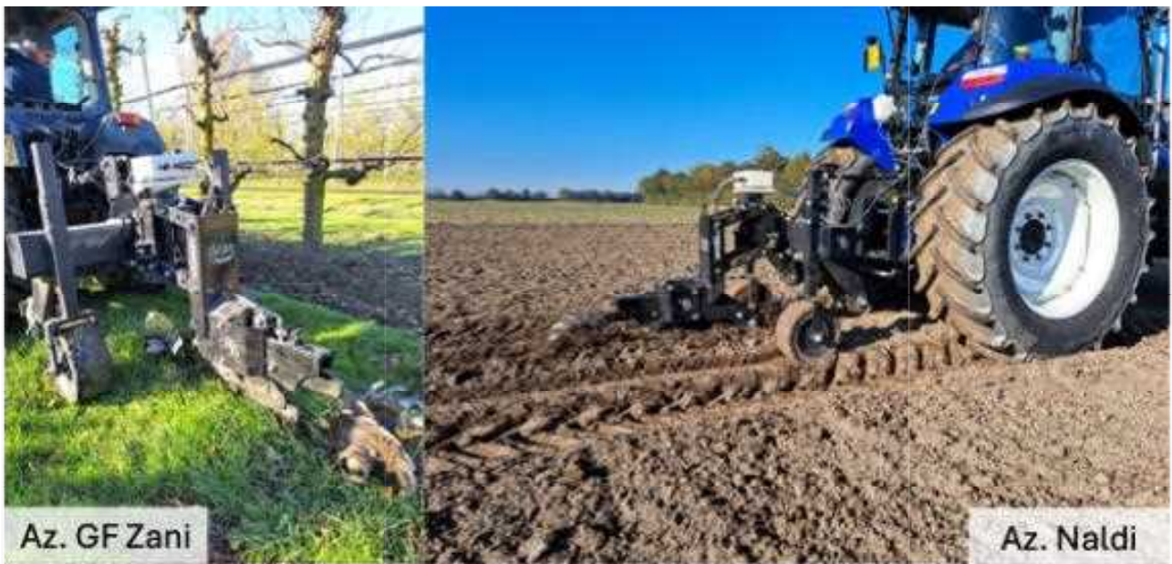
Figura 22 Momenti del passaggio del sensore iScan PRO montato sull'attacco a tre punti presso le aziende GF Zani (interfila di un pereto - 7/12/2023) e DeltaBio (terreno arativo - 17/11/2023)
