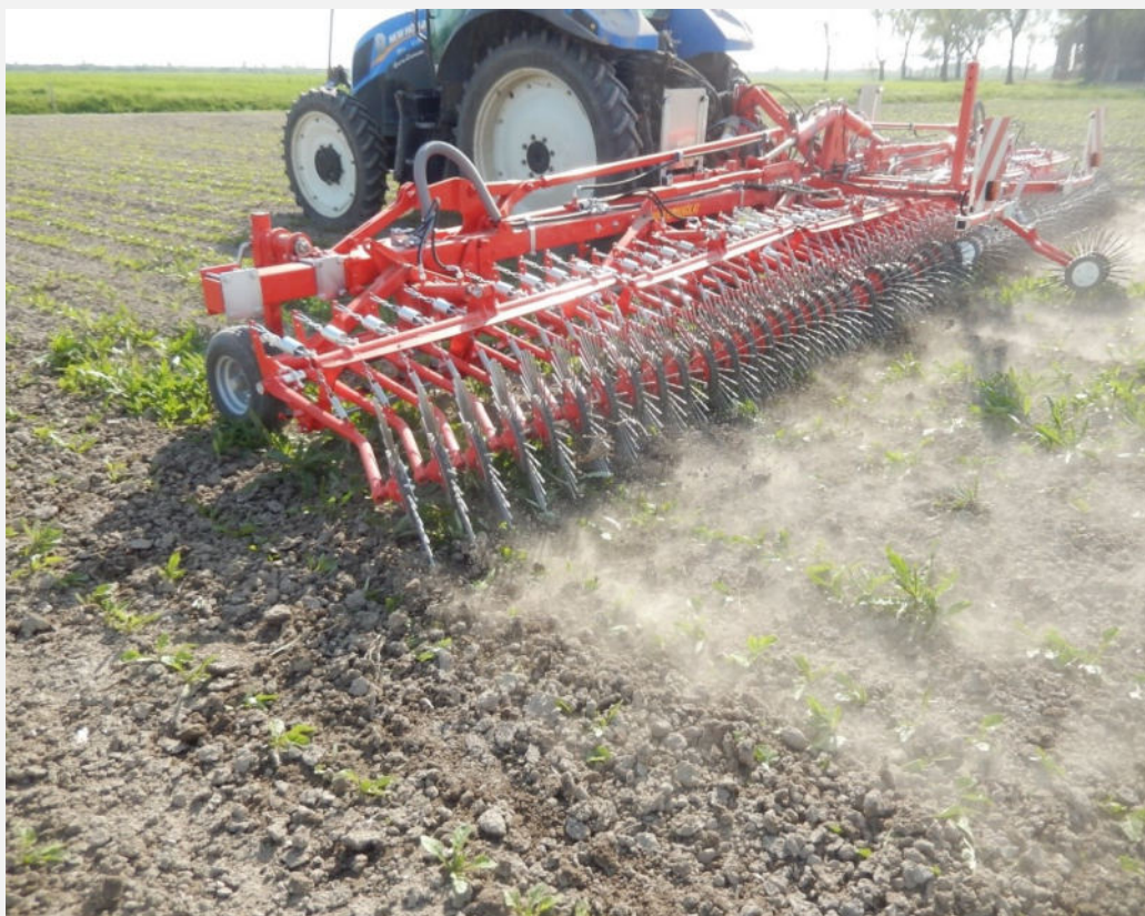
Rompicrosta stellare in azione su bietole già di una certa dimensione.
