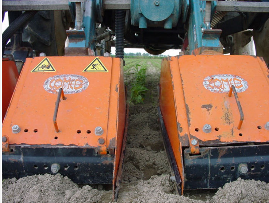
Particolare degli elementi scatolati con la fila di bietole al centro in secondo piano.
