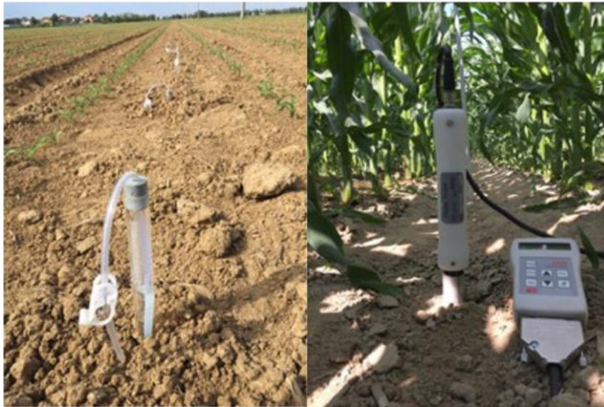
Figura 9 Set di lisimetri per il campionamento della soluzione circolante del suolo e sonde per il monitoraggio del contenuto idrico del suolo
