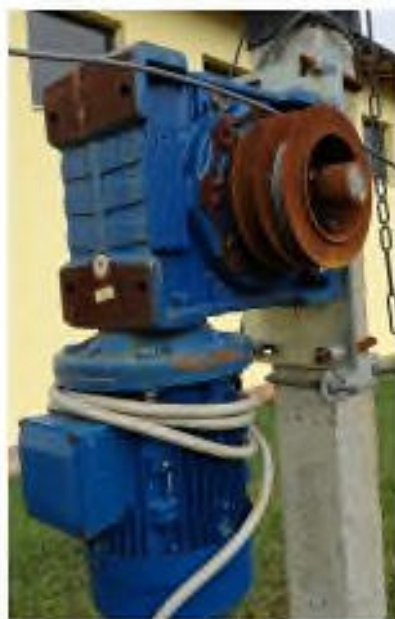
Particolare dei due sistemi di apertura e chiusura dei teli: con motoriduttore (a sinistra) o con trattore (a destra)
