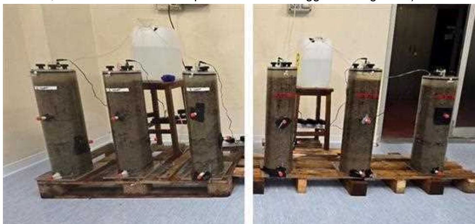
Figura 6.2. Allestimento sperimentale delle 6 carote di suolo (le 3 carote a sinistra sono le carote destinate al controllo, 3 carote di destra sono quelle a cui è stato aggiunto il digestato).
