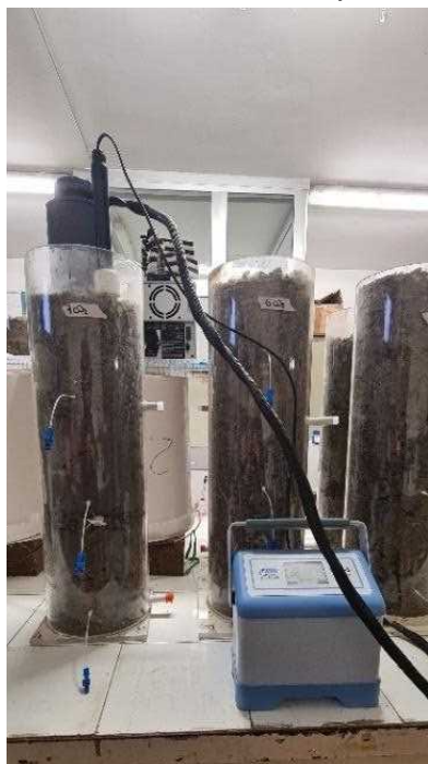
Figura 5.2 Misura dell'emissione di CO 2 da una carota di suolo in seguito all'aggiunta di digestato attraverso l'utilizzo del Portable CO 2 Gas Analyzer EGM-5 - PP systems nei laboratori di Ecologia delle acque dell'Università di Ferrara.
