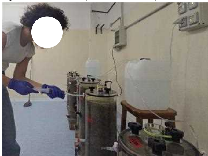
Figura 7.2. Fase di campionamento dell'acqua sovrastante ogni carota per il monitoraggio delle specie azotate.
