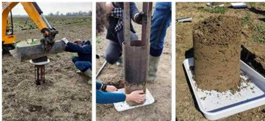
Figura 1.2: Fasi del campionamento delle carote di suolo in strati di 20 cm (0-20, 20-40, 40-60 cm dalla superficie del suolo) con l'utilizzo di un carotatore di acciaio.
