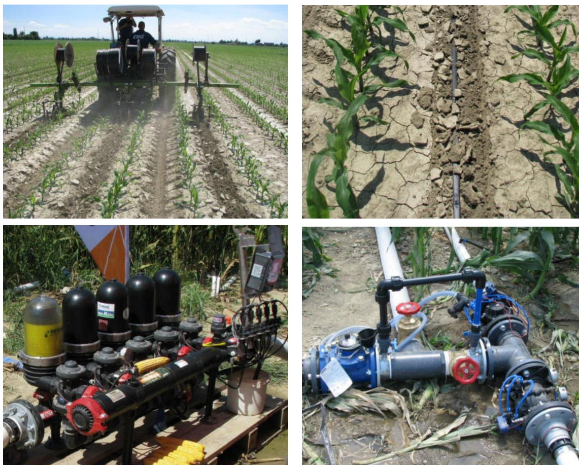
Figura 6 – Diverse componenti dell’impianto di fertirrigazione con ali gocciolanti
