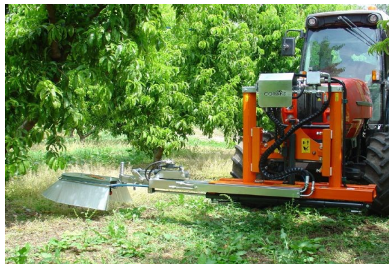
Irroratrici schermate per il trattamento localizzato nel sottofila delle colture arboree
