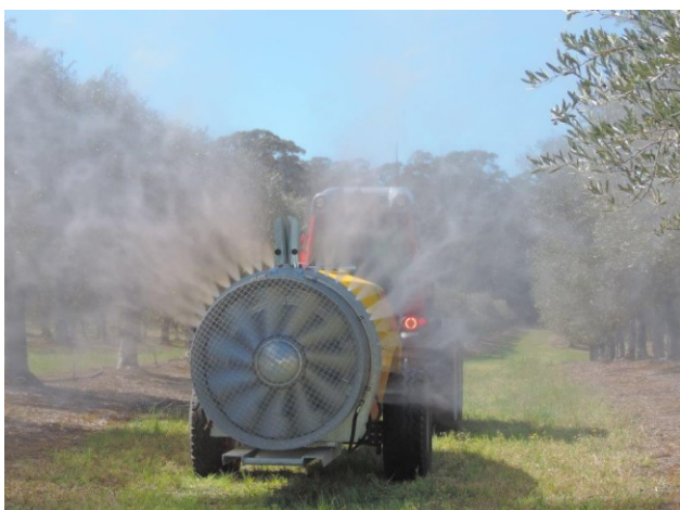
Atomizzatore ad aeroconvezione tradizionale
