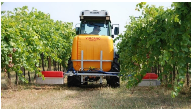
Irroratrici schermate per il trattamento localizzato nel sottofila delle colture arboree
