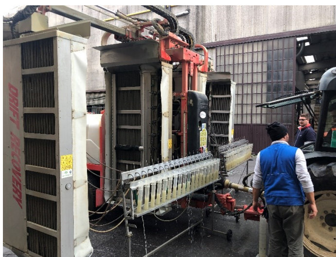
Atomizzatore a tunnel con recupero
