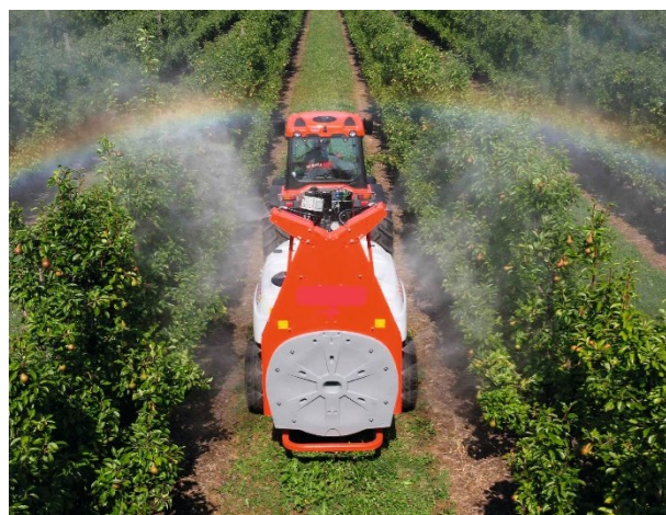
Atomizzatore ad aeroconvezione a torretta
