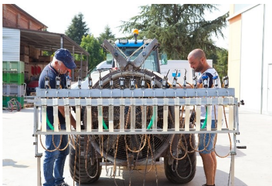
Verifica dello stato di usura degli ugelli
