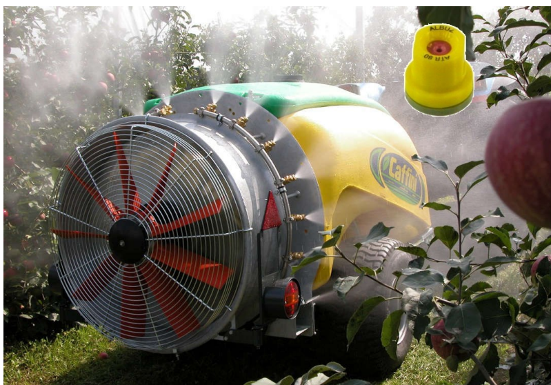
Atomizzatore ad aeroconvezione tradizionale
