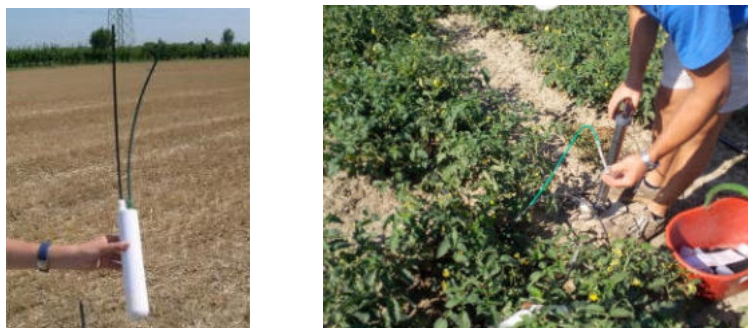
Fig. 26 – Lisimetro a suzione: conformazione (sx) e suo utilizzo in campo (dx).
