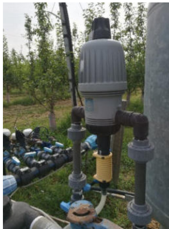
Fig. 5 – Particolare della pompa dosatrice impiegata nella prova.
