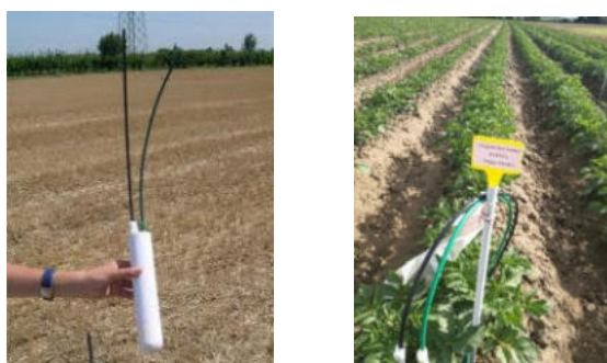
Fig. 26 – Lisimetro a suzione: conformazione (sx) e suo posizionamento sulla coltura (dx).
