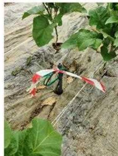
Fig. 12: Lisimetro a suzione: conformazione (sx) e suo posizionamento sulla coltura (dx).
