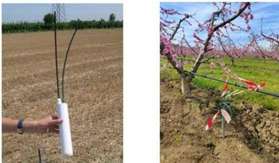
Fig. 12: Lisimetro a suzione: conformazione (sx) e suo posizionamento sulla coltura (dx).
