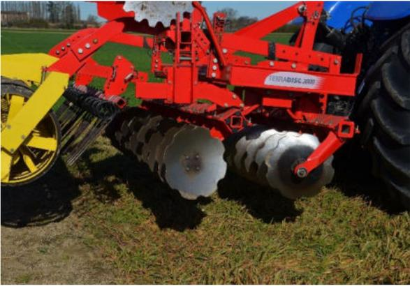
In alternativa l'interramento dei residui della cover crop successivamente alla trinciatura può essere effettuato con **erpici a dischi** o "dischiere" trainate, in grado di operare una rottura del cotico superficiale ed un contemporaneo parziale interrimento del residuo vegetale.
