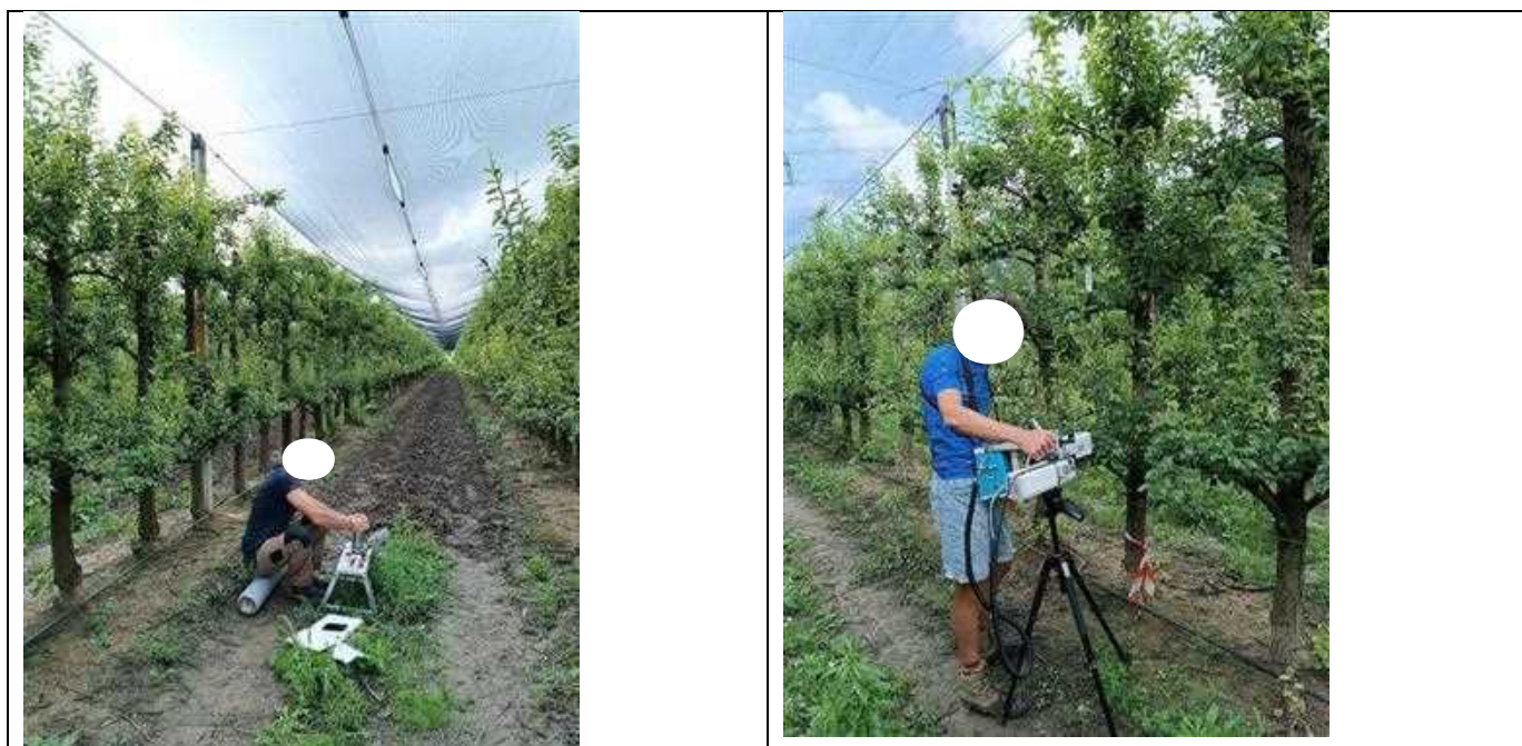
Fig.2 - A sinistra le misurazioni effettuate con la camera di Scholander, per valutare lo stato idrico; A destra LICOR-6800 per valutare la performance fotosintetica a livello fogliare
