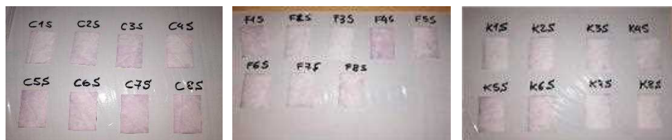
Fig. 2 - immagini delle cartine sulle quali si è sviluppato il colore rosa segno della presenza di rame.
