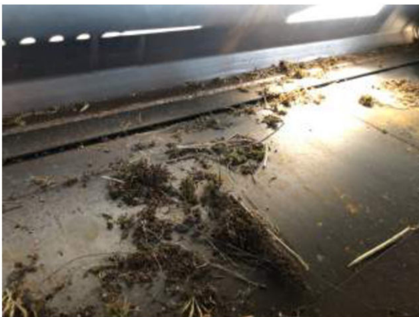
Fig. 9 : Tramoggia interna alla macchina per la raccolta delle infiorescenze/semi
