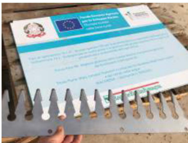
Fig. 2 Modulo stripper in acciaio (ditta Shelbourne)
