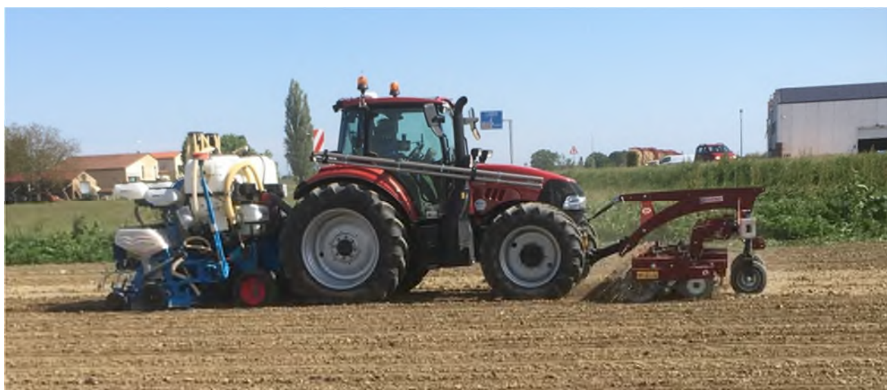
Figura 3.4.12: itinerario B innovativo: Preparatore Badalini montato anteriormente alla trattrice
