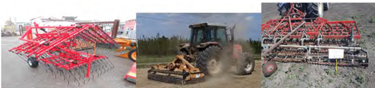
Figura 3.4.2: Tipologie di attrezzature utilizzate nell'itinerario C tradizionale, Erpice strigliatore, Rotante, Minitiller
