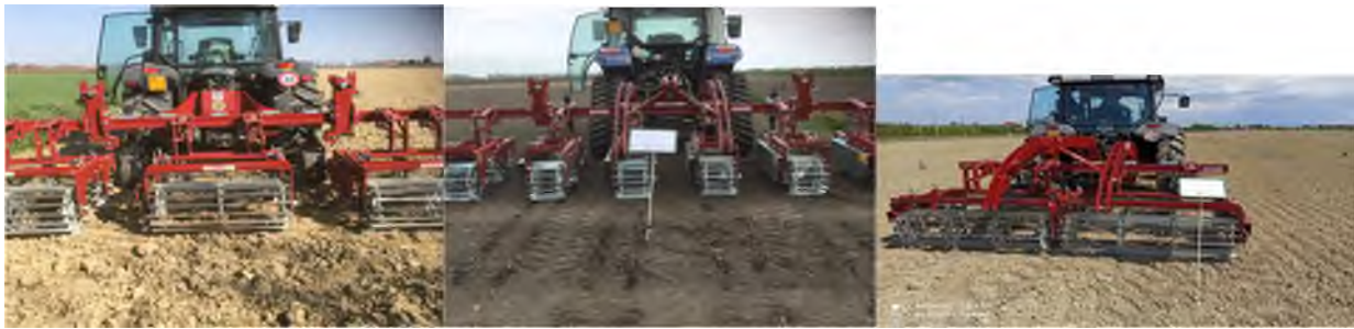
Figura 3.4.1: Attrezzatura utilizzata nell'itinerario B innovativo: Preparatore Badalini in diversi allestimenti (A bande di 90 cm spaziate di 60; A bande di 30 cm spaziate di 40; A rulli affiancati per una larghezza di 2.7 m)
