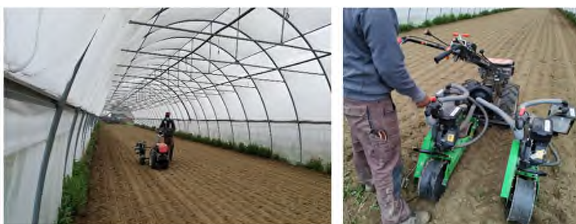
Figura 3.2.1.1 – Serra ove è stata svolta la prova, durante la fase di semina (sx); seminatrice pneumatica sperimentale (dx)
