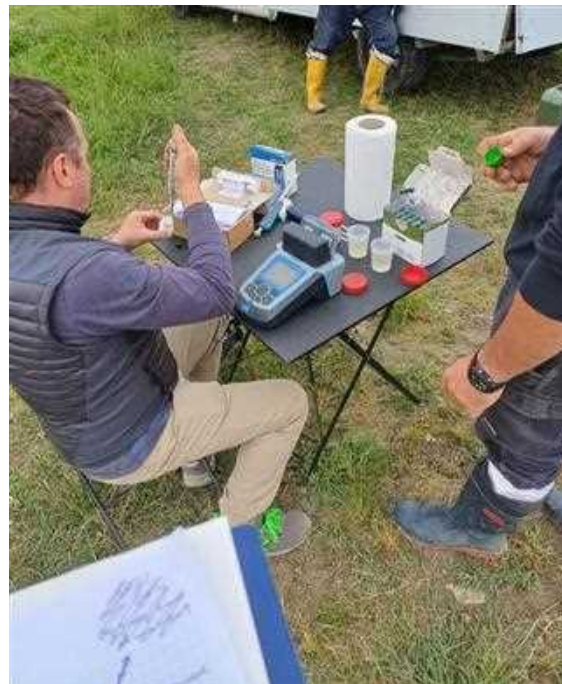
Figura 20 Misurazione delle concentrazioni in uscita con kit per indagine azoto e spettrofotometro (DR1900 Hach Lange)
