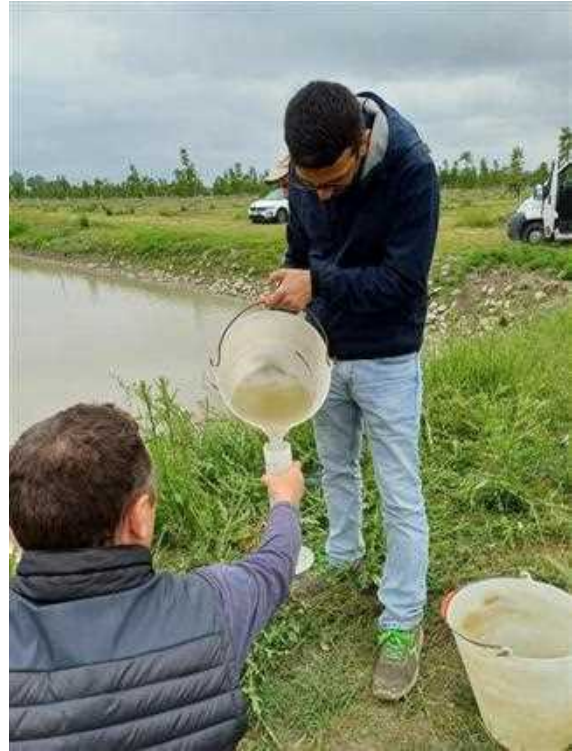
Figura 19 Misura in campo della portata in uscita
