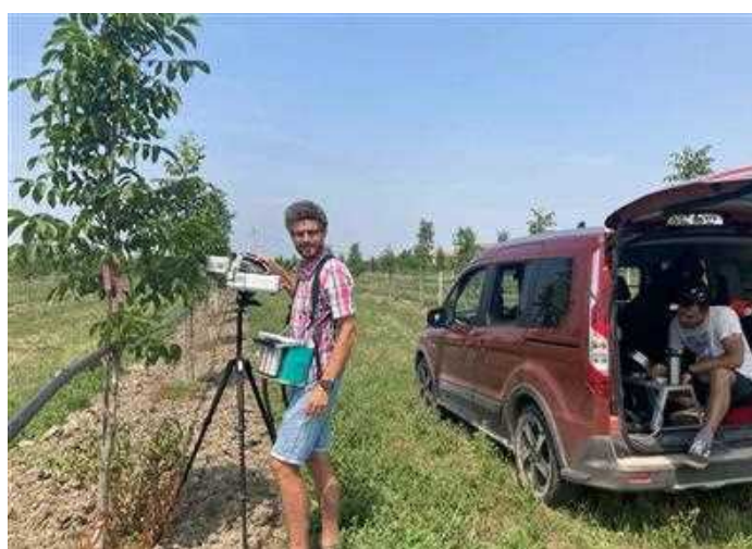
Figura 8 Misura degli scambi gassosi con LiCOR 6800 (sx) e potenziale idrico di foglie e tronco con camera di Scholander (dx)
