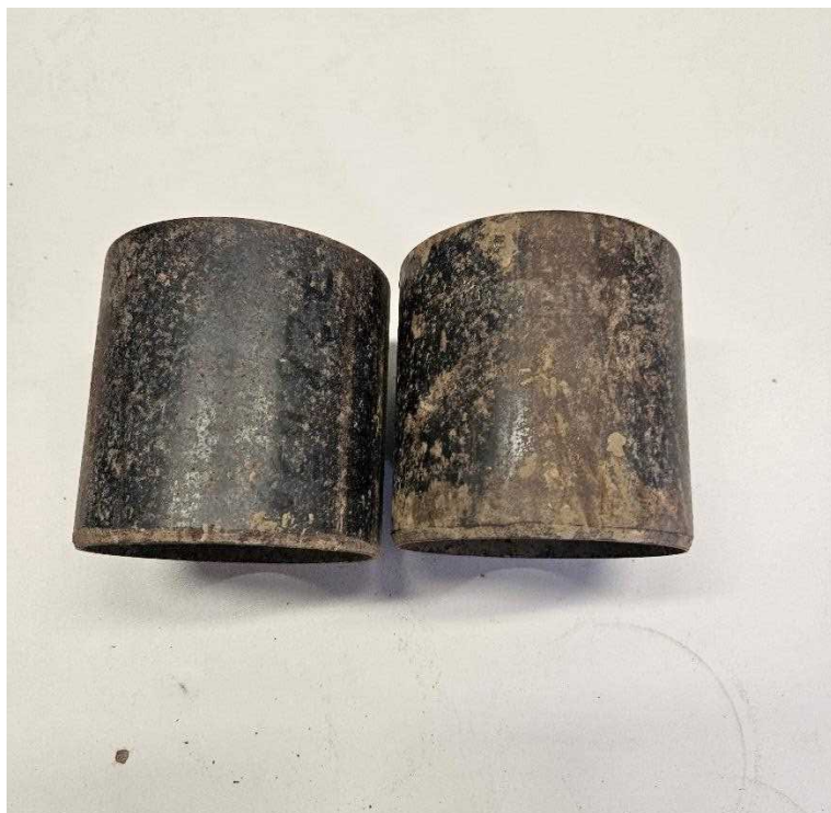
Figura 8 Cilindri a volume noto per la determinazione del peso specifico apparente del terreno
