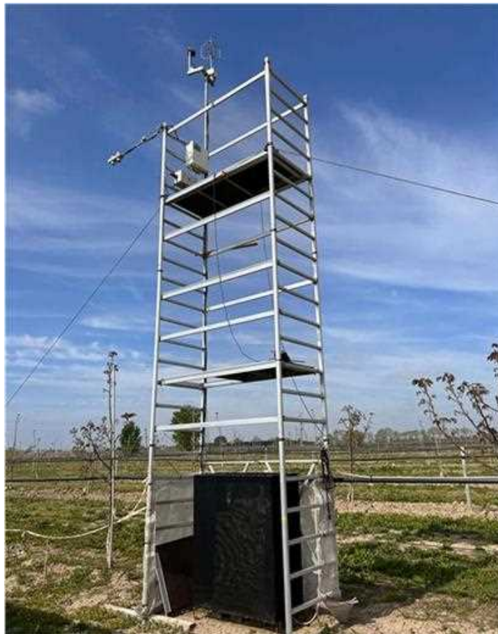
Figura 15 Strumentazione eddy covariance installata nel noceto
