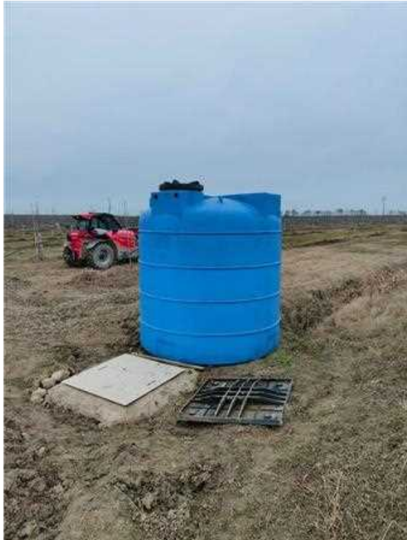
Figura 18 Tank utilizzato per l'introduzione dei volumi all'interno del bioreattore
