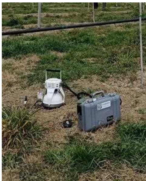
Figura 5. Cameretta dinamica e analizzatore di protossido di azoto.
