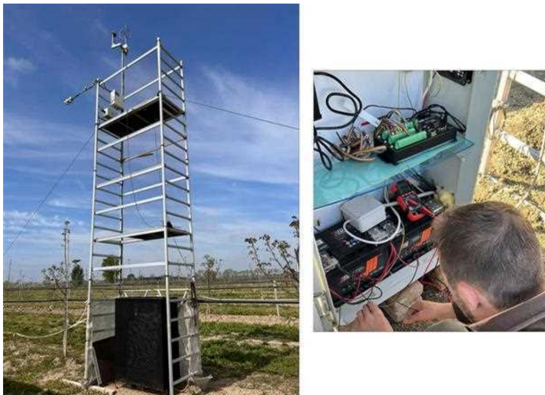
Figura 1: torre di misura eddy-covariance (sx) e sistema di acquisizione dati(dx).
